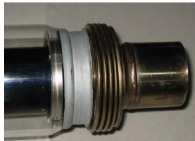
Şekil 5.8. Körüklü cam-metal ile birleştirilmiş emici boru-cam örtü birleşimi yandan görünüşü
