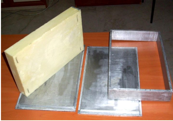
Şekil 3.8 Numunenin kalıptan çıkarılması
