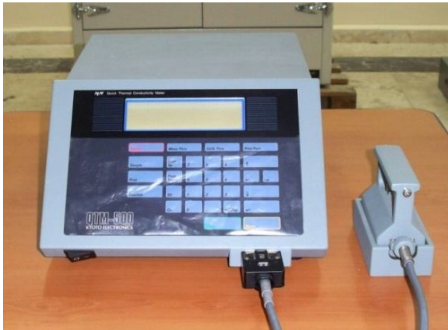
Şekil 3.26 Kyoto QTM-500 ısı iletim katsayısı ölçüm cihazı
