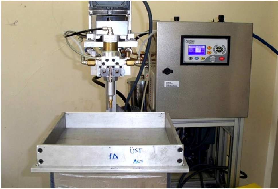
Şekil 3.17 Kalıbın PU enjeksiyon makinesi altına yerleştirilmesi
