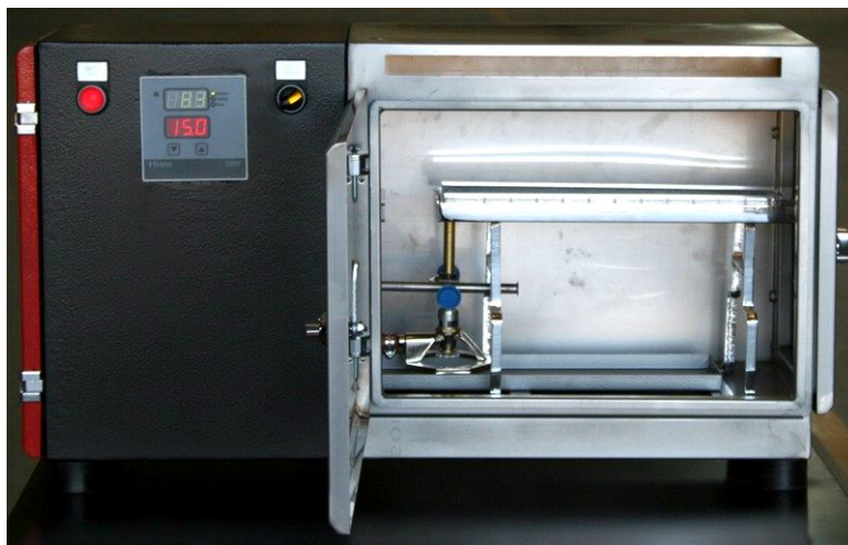
Şekil 3.29 MVSS 302 yanma test cihazının ön görünüşü
