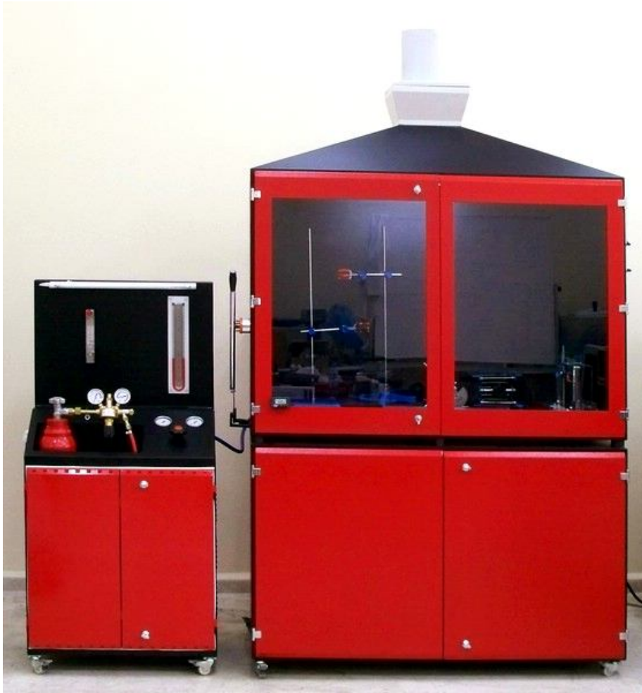
Şekil 3.34 UL 94 yanma test cihazı
