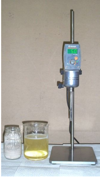
Şekil 3.22 Homojenize işlemi öncesi alev geciktirici, poliöl ve homojenizatör
