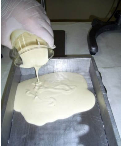
Şekil 3.5 Karışımın kalıba dökülmesi
