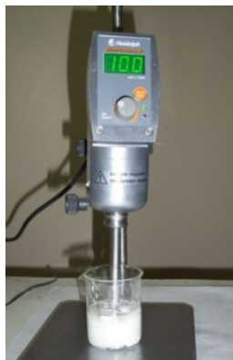
Şekil 3.2 Alev geciktiricinin homojenizatör kullanılarak poliöl içerisinde dağılması
