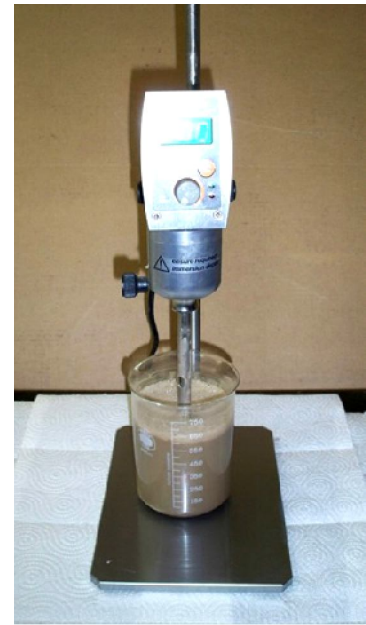
Şekil 3.23 (a) Homojenizatör altına poliölün yerleştirilmesi, (b) poliole alev geciktirici ilavesi ve (c) homojenize işlemi
