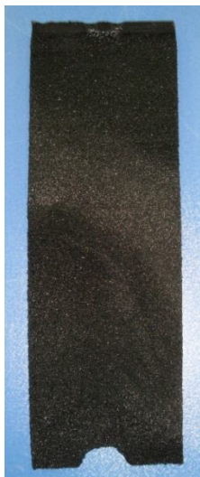
Şekil 4.34 PUI malzemenin MVSS 302 yanma testi sonrası görünümü
