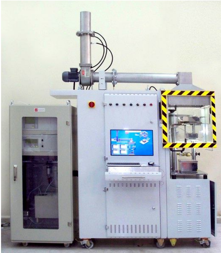
Şekil 3.39 Konik kalorimetre yanma test cihazı
