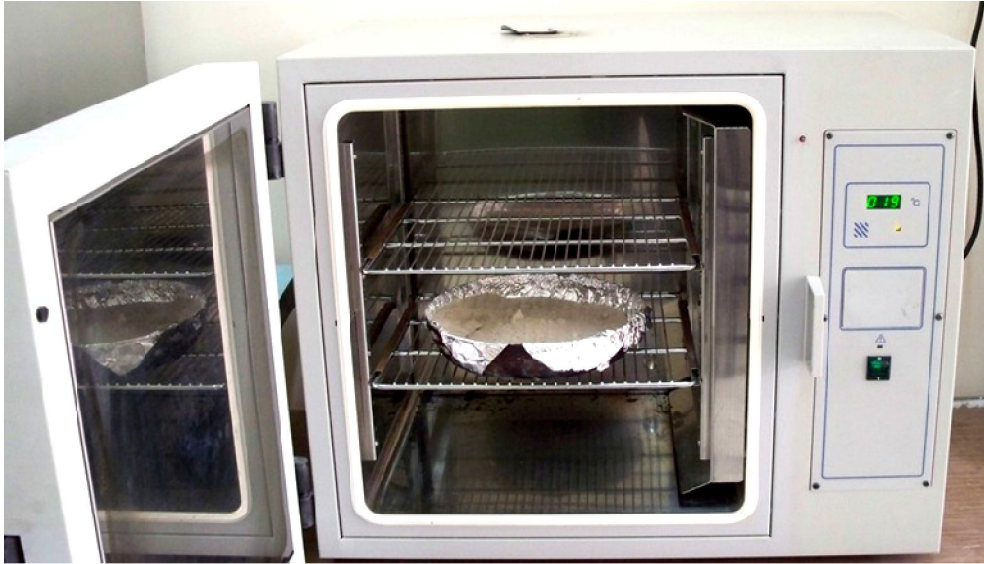
Şekil 3.25 Alev geciktiricinin fırında kurutulma işlemi
