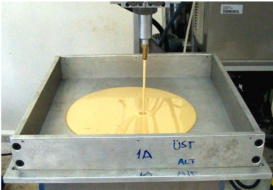
Şekil 3.18 Sıvı poliüretanın kalıba dökülmesi
