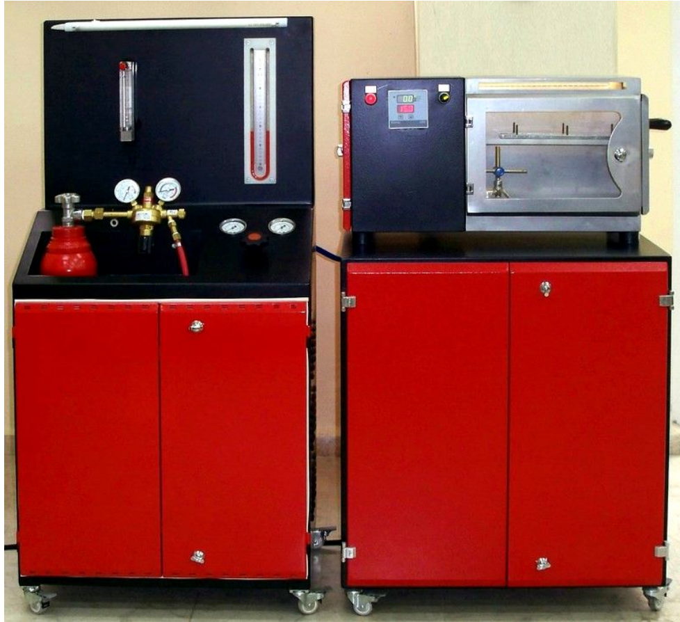
Şekil 3.30 MVSS 302 yanma test cihazı
