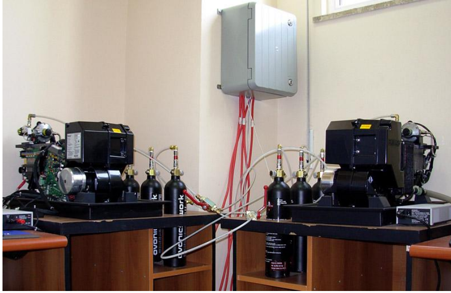
Şekil 5.9 Nexa yakıt pili modülleri ve metal hidrid hidrojen tankları
