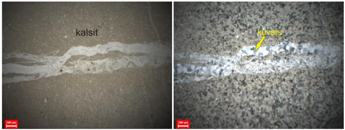
Şekil 3.23: Sparitik kireçtaşı örneğindeki kalsit minerali ve damarlarda gelişmiş kuvars kristali (sol taraf tek sağ taraf çift nikol; Ölçek 500µm)
