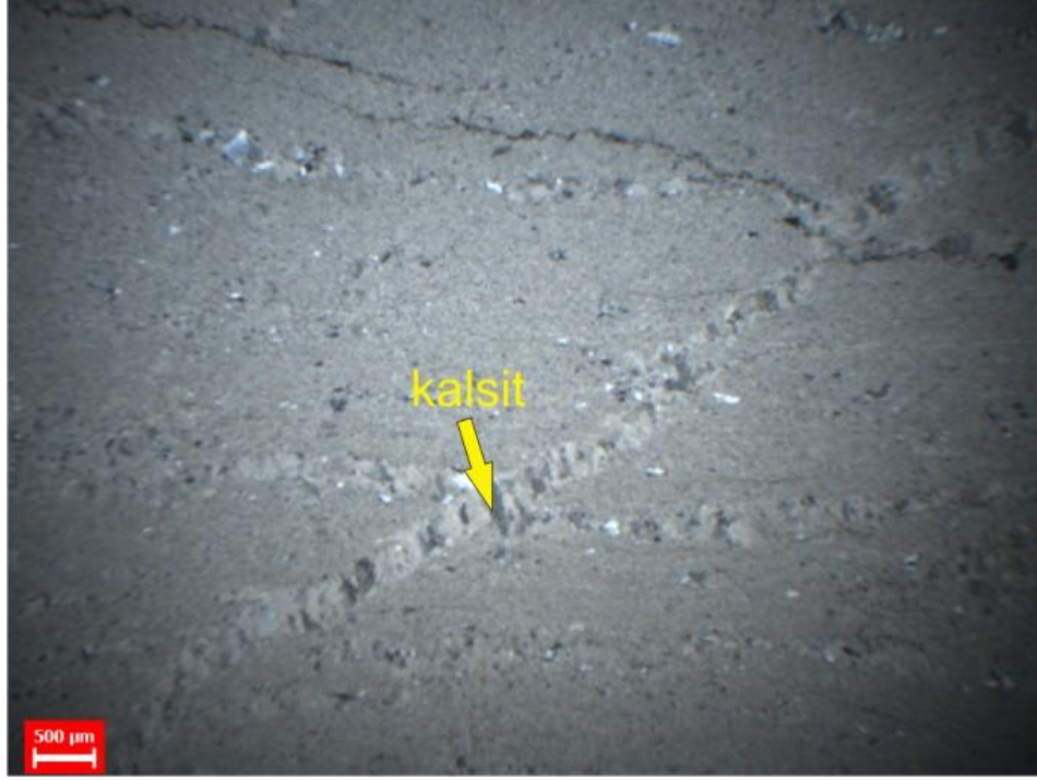
Şekil 3.5: DUP 44 nolu sparitik kireçtaşının damarlarında gelişen kalsit mineralinden görünüm.
