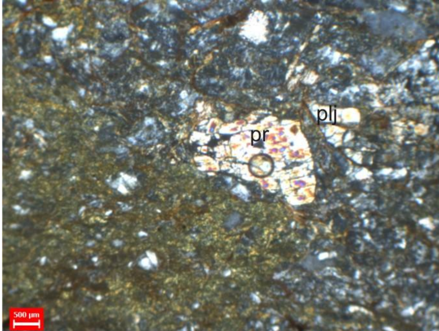
Şekil 3.6: Metabazit örneği içindeki yarıözşekilli piroksen ve plajiyoklas mineralleri (pr; piroksen, plj;plajiyoklas).
