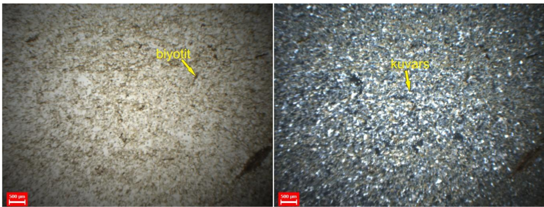
Şekil 3.4: DUP 80 nolu silttaşı numunesindeki kuvarş ve biyotit mineralleri(ölçek500µm).
