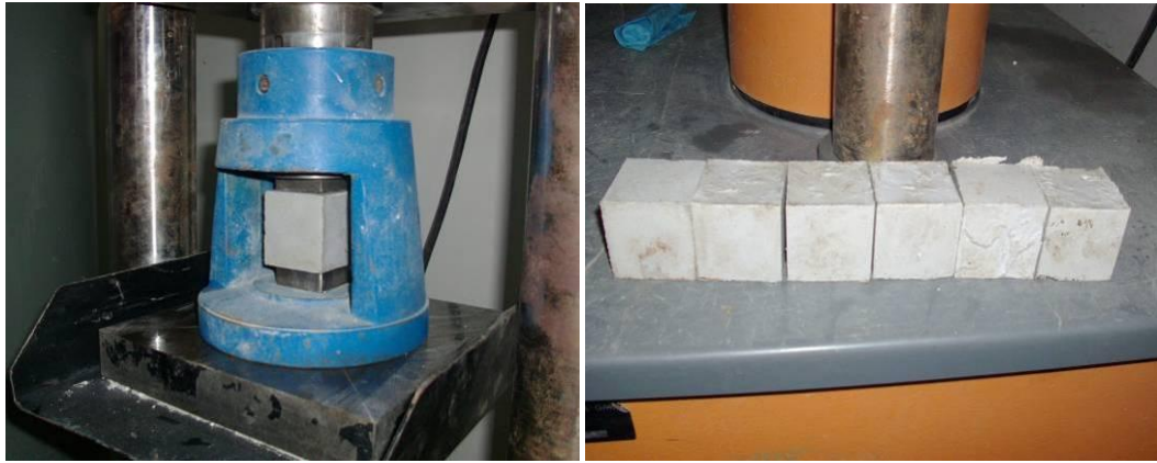
Şekil 4.4 : Epoksi basınç deneyi
