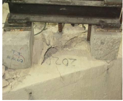
Betonun yarılması ve konik kopma f20c20
