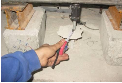
Konik kopma ve sıyırılma f16c24
