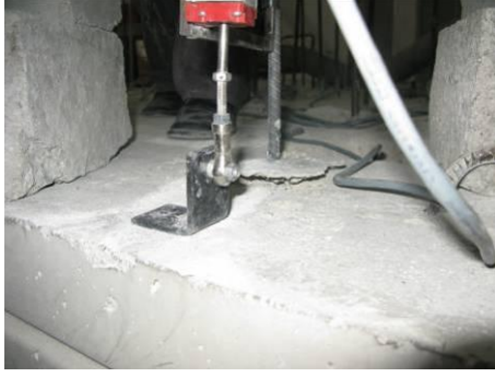
Konik kopma ve sıyırılma f12c24
