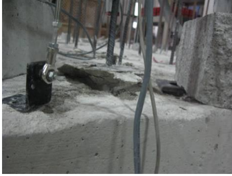
Konik kopma ve sıyırılma f12c18
