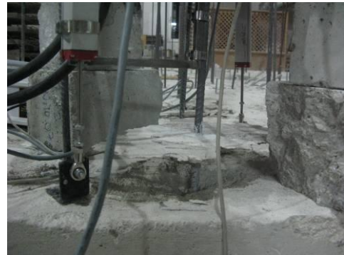
Konik kopma ve sıyırılma f12c18
