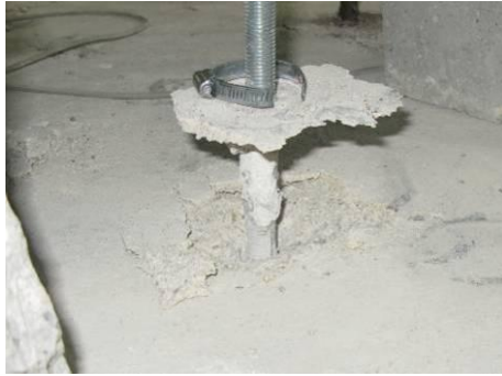
Konik kopma ve sıyırılma f16c32
