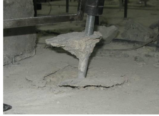
Konik kopma ve sıyrılma f16c16
