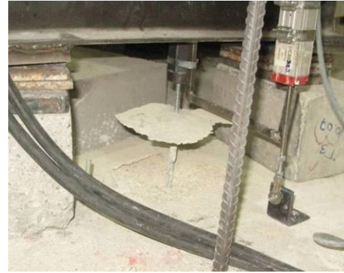
Konik kopma ve sıyırılma f8c16
