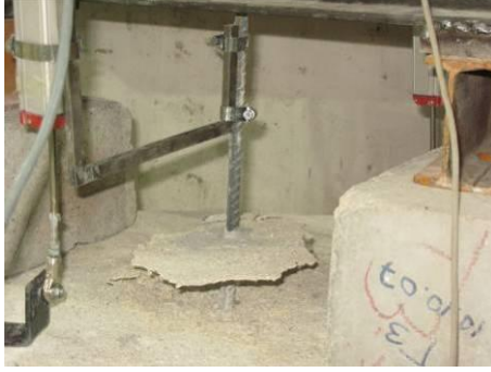
Konik kopma ve sıyırılma f12c12
