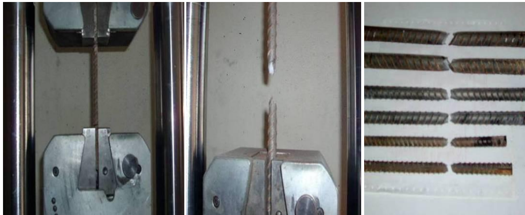
Şekil 4.7 : S420a donatı çekme testi
