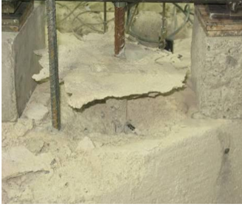
Konik Kopma ve sıyrılma f20c20
