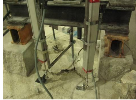
Konik kopma ve sıyırılma f12c24
