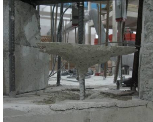
Konik kopma ve sıyırılma f16c16
