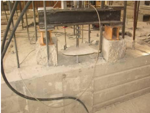
Konik kopma ve sıyırılma f16c16
