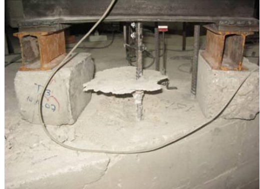
Konik kopma ve sıyırılma f16c16
