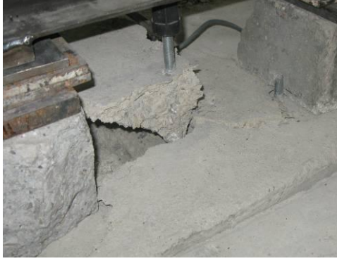
Konik kopma ve sıyrılma f16c16
