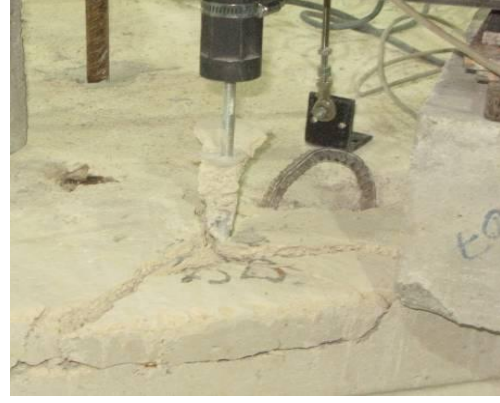
Betonun yarılması f8c8
