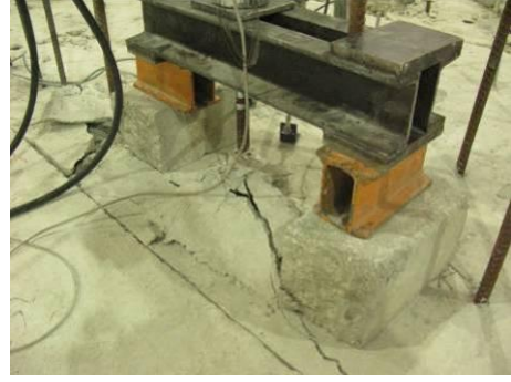
Betonun yarılması f20c20
