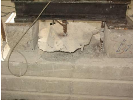
Konik kopma ve sıyırılma f20c20
