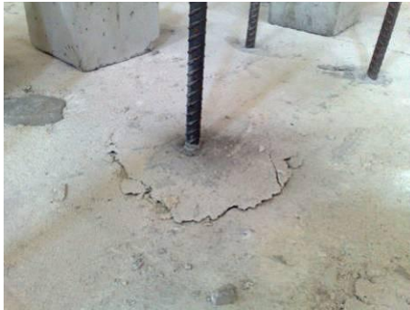
Konik kopma ve sıyırılma f12c24
