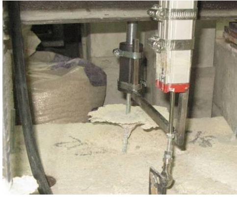
Konik kopma ve sıyırılma f8c12
