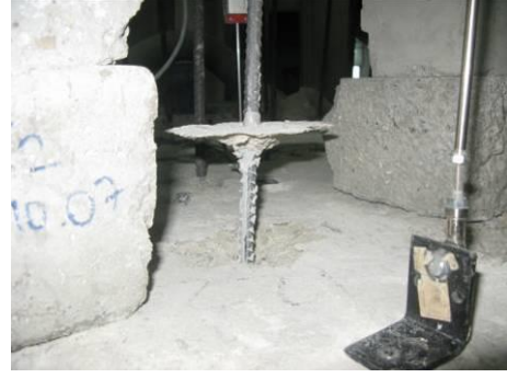
Konik kopma ve sıyırılma f12c24
