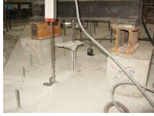
Konik kopma ve sıyırılma f16c50
