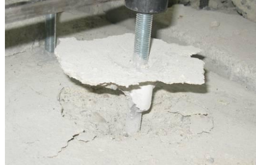
Konik kopma ve sıyırılma f16c16
