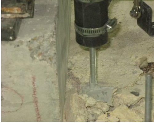
Konik kopma ve sıyırılma f8c8
