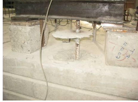
Konik kopma ve sıyırılma f20c20
