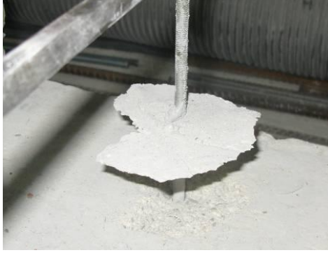
Konik kopma ve sıyırılma f8c8
