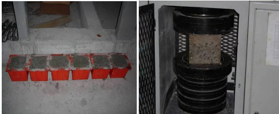
Şekil 4.6 : Betonlardan numune alınması ve basınç deneyine tabi tutulması
