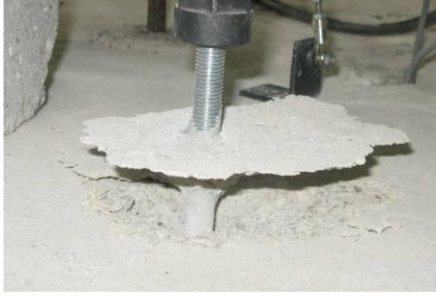
Konik kopma ve sıyırılma f16c16
