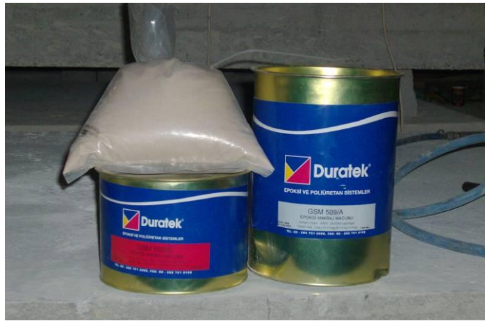
Şekil 4.3 : Kullanılan epoksi esaslı kimyasal yapıştırıcı
