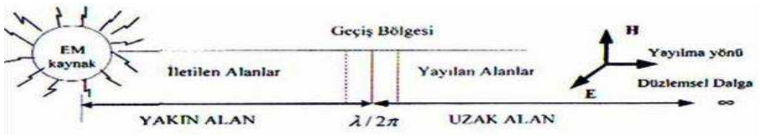
Şekil 2.7 : EM radyasyon kaynağı ve girişim alanlarının tanımı (Arı ve Özen, 2008)
