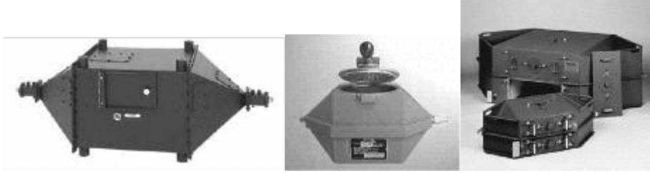
Şekil 2.15 : Bilinen TEM hücrelerin çeşitli konfigürasyonları (Montrose ve Nakauchi, 2004)
