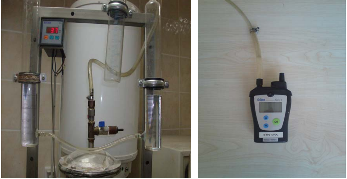
Şekil 3.5 Toplam gaz miktarının ölçüldüğü düzenek ve Dräger ® Ex cihazı
