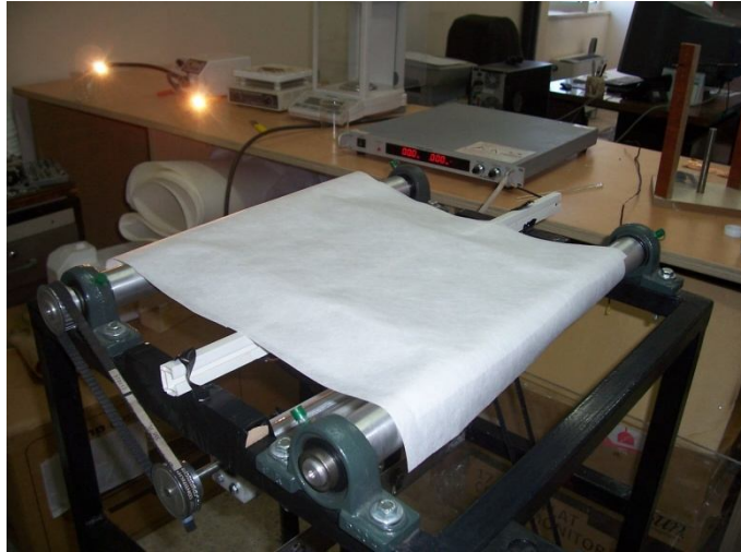
Şekil 3.9: Filtrasyon örnekleri hazırlamak için tasarlanan nanolif yüzey elde etme sistemi
