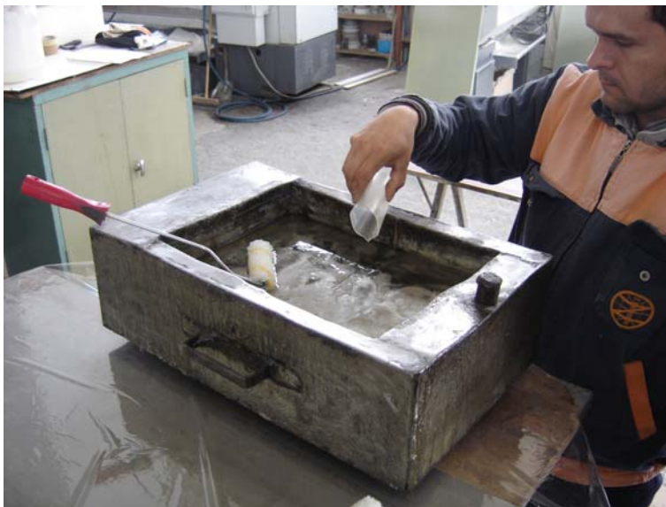
Şekil 3.18 Epoksi reçineye katalizör ilavesi
