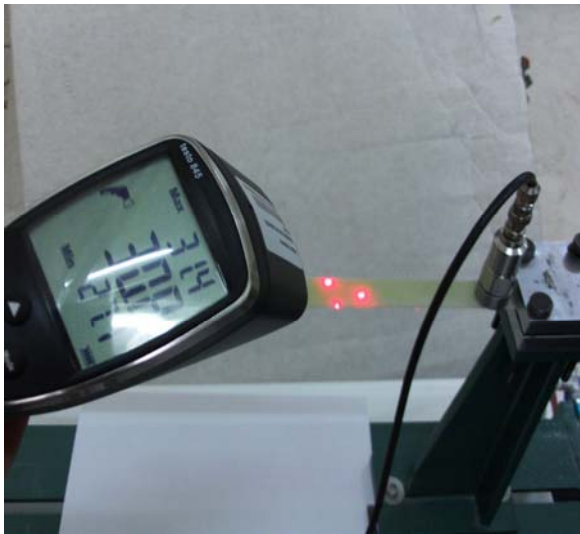
Şekil 5.61 Lazer termometresi ile ısı ölçümü
