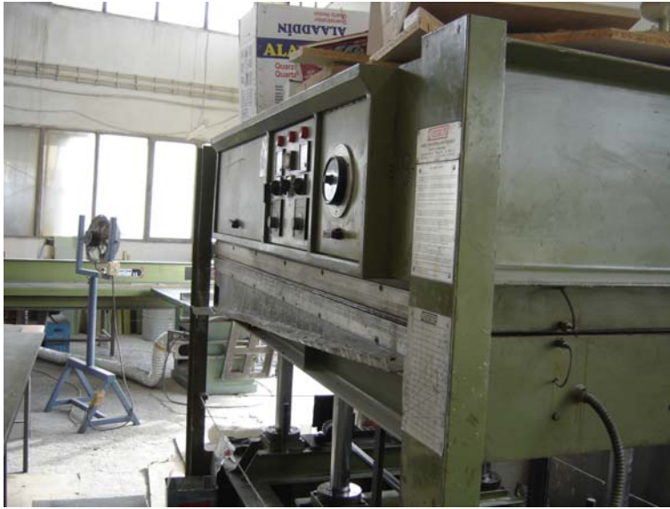
Şekil 3.19 Rezistanslı hidrolik pres
