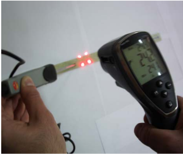
Şekil 5.60 Lazer termometresinin ayarlanması
