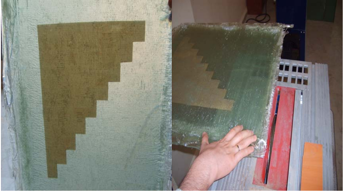
Şekil 3.14 Delaminasyonlu tabakalı kompozit plakanın kesimi
