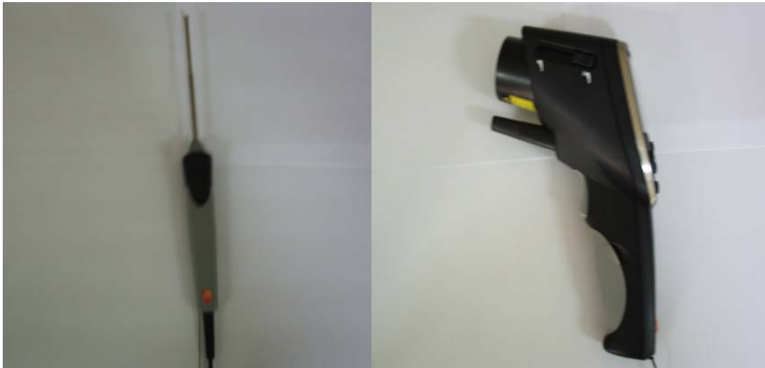
Şekil 5.59 Testo845 lazer termometresi ve probu
