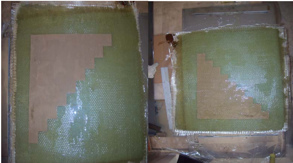
Şekil 3.13. Delaminasyonlu tabakalı kompozit plaka
