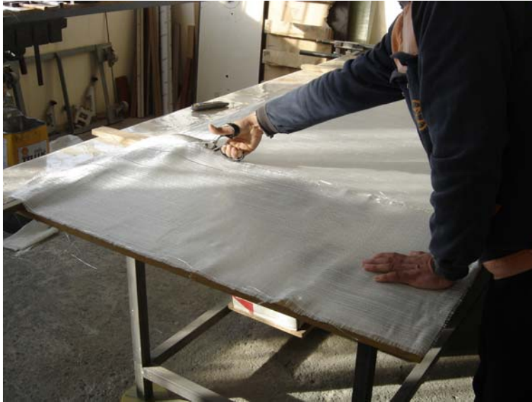
Şekil 3.17 Cam elyaf kumaşının açılı kesimi
