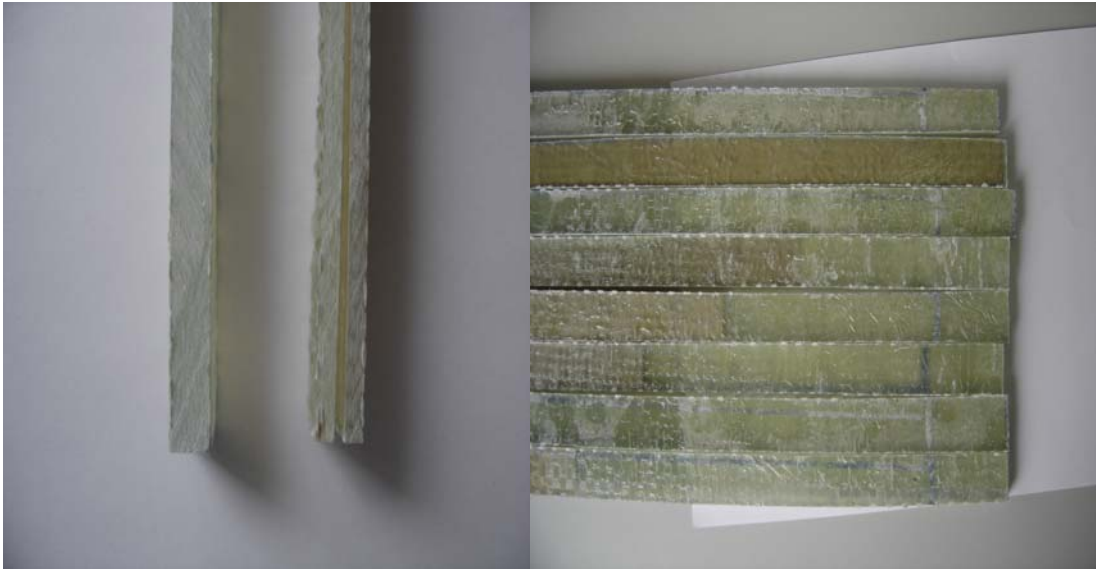
Şekil 3.15 Delaminasyonlu tabakalı kompozit kiriş
