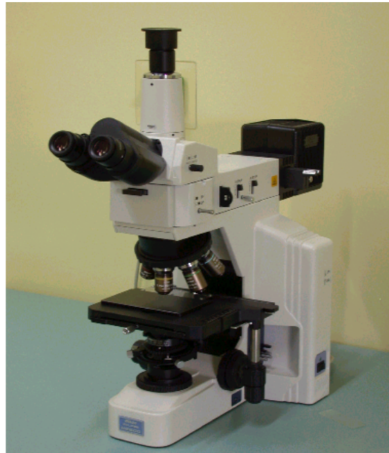
Şekil 3.8: Nikon ECLİPSE ME600 marka polarize ışık mikroskobu.
