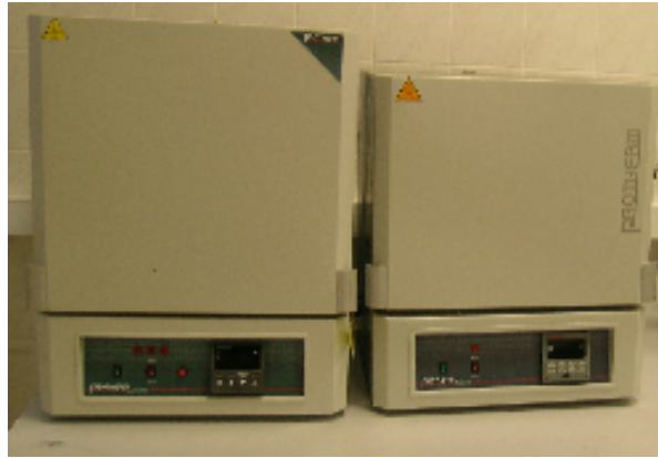
Şekil 3.1 Honeywell sıcaklık kontrol ünitesi Protherm marka kare fırın.
