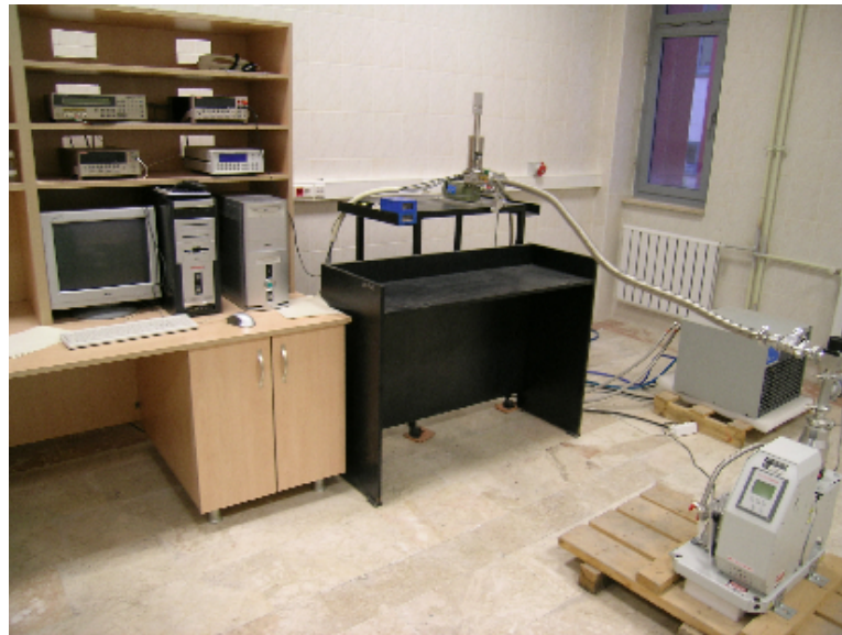
Şekil 3.9: Sıcaklığa bağlı direnç ölçüm sistemi.
