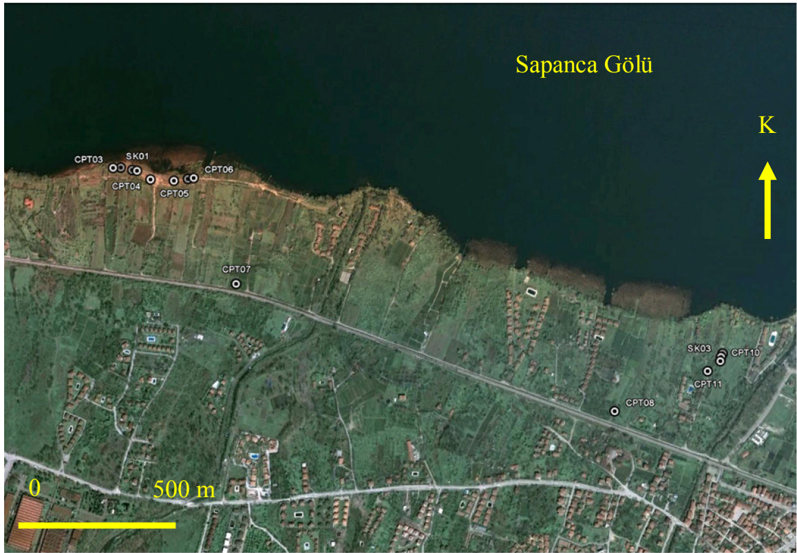
Şekil 6.1 İnceleme alanında yapılan SPT ve CPT deneylerine ait yerbulduru haritası
