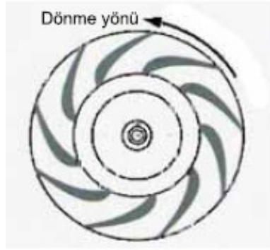
Şekil 4. 6. Uçak kanadı kesitli merkezkaç vantilatör (WEB_4 2010)
