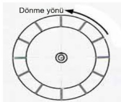
Şekil 4.4. Düz kanatlı kanal merkezkaç vantilatör (WEB_4 2010)
