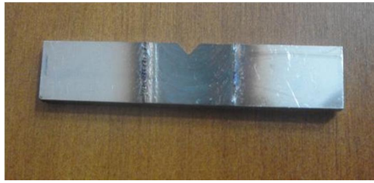
ekil 3.19: Çentik darbe deneyi numunesi ve boyutları
