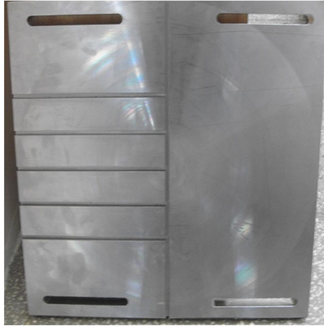
ekil 3.4: zerinde ısı lme kanalları bulunan ana tabla
