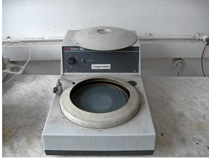
ekil 3.25: Numunelerin zımparalanmasında kullanılan Metkon marka sulu zımpara makinesi
