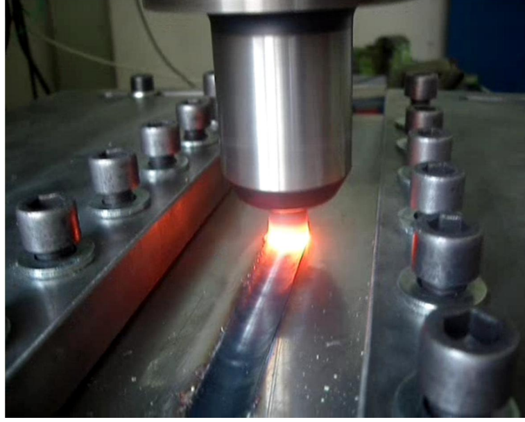
ekil 2.8: Aynı takım baskı kuvvetinde ilerleyen kaynak görünümü
