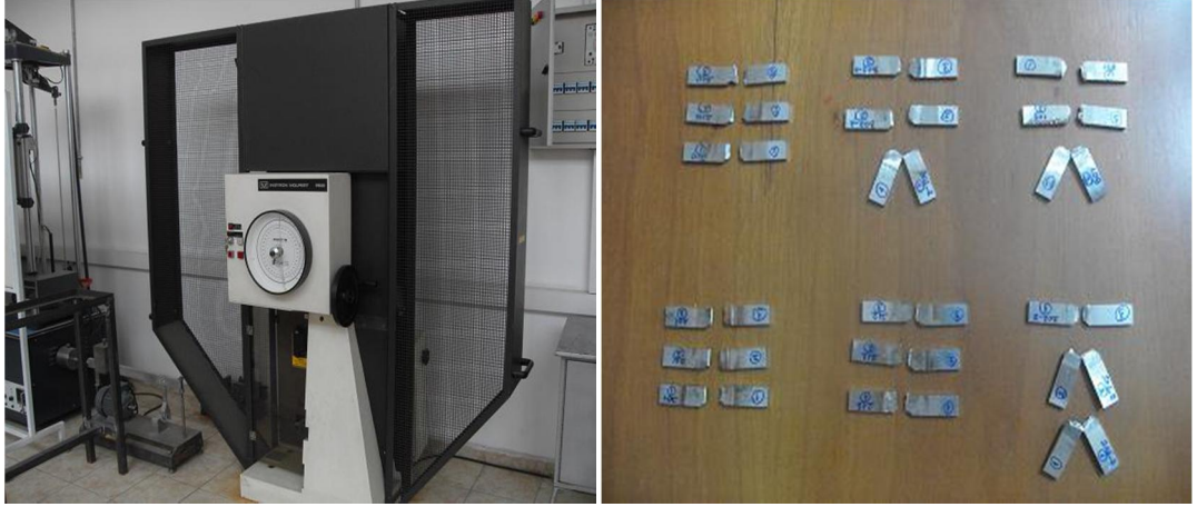
ekil 3.23: Instron Wolpert PW30 çentik darbe deney cihazı ve deney sonrası numunelerin görünüşleri
