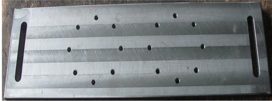
ekil 3.2: Yük hücrelerini frezeyle ba layan alt tabla
