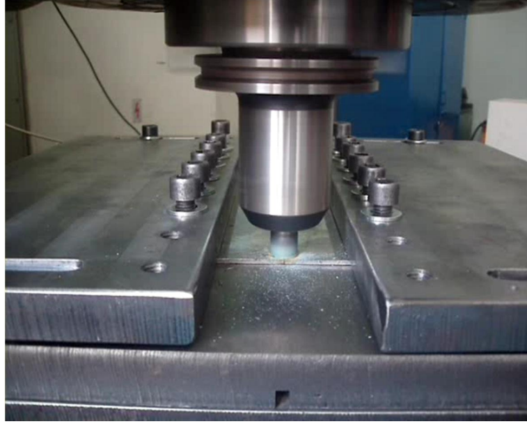
ekil 2.4: Karı tırıcı takım omzunun istenilen baskı kuvvetinde istikrarlı olarak levhalara srtnmeye devam etmesi
