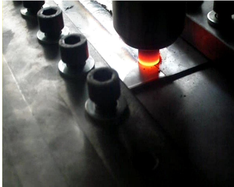
ekil 2.9: Kayna ın sonuna yakla ılması
