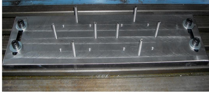
ekil 3.8: Alt tablanın frezeyle sabitlenmesi
