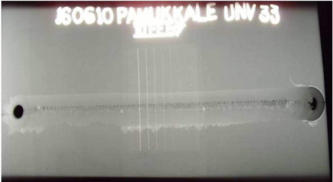
ekil 5.9: Radyografik inceleme yapmak amacıyla çekilen örnek bir numuneye ait röntgen filmi (1120 min -1 , 125 mm/min, 3,5 kN, ve 1,5 )
