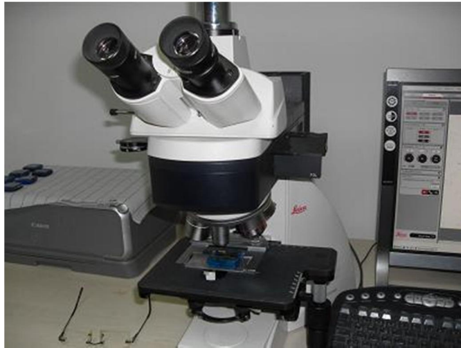
ekil 3.28: Mikroyapı incelemede kullanılan Leica marka 1 ık mikroskobu
