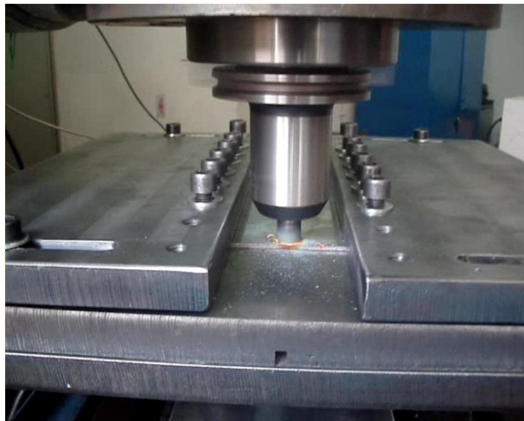
ekil 2.5: Takım omzunun sıcaklık etkisiyle kızarmaya ba laması
