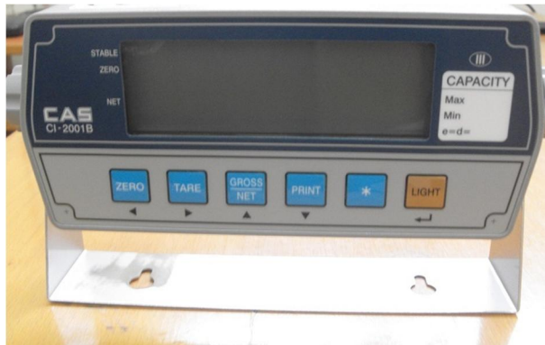
ekil 3.7: CAS marka yük hücresi indikatörü
