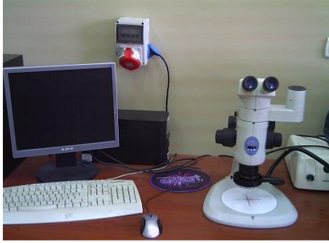
ekil 3.27: Makroyapı incelemede kullanılan Nikon SMZ 1500 marka stereo mikroskop
