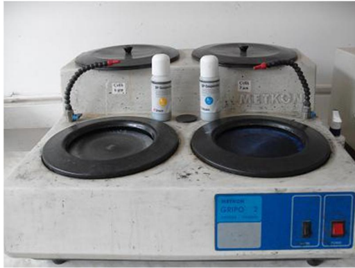
ekil 3.26: Numunelerin parlatılmasında kullanılan Metkon marka parlatma makinesi
