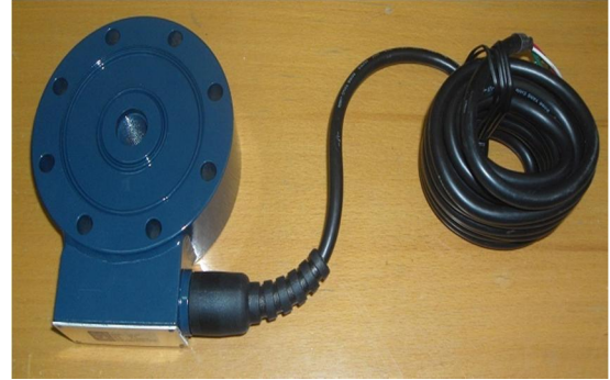
ekil 3.6: CAS marka 5 tonluk yük hücresi (loadcell)
