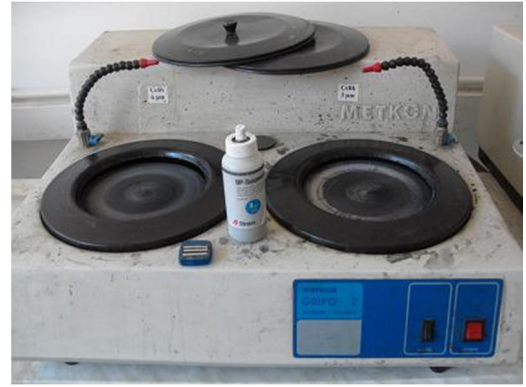
ekil 3.26: Numunelerin parlatılmasında kullanılan Metkon marka parlatma makinesi
