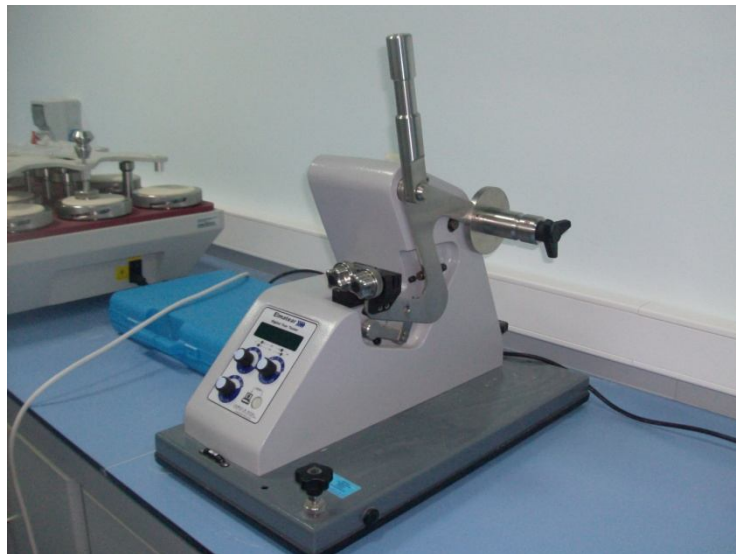
Şekil 6.8 : Yırtılma mukavemeti deney cihazı
