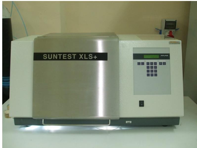
Şekil 6.3: SUNTEST XLS+ güneş simülatörü
