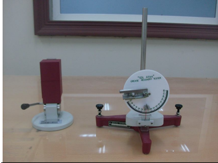
Şekil 6.9: Kat açılma açısı deney cihazı
