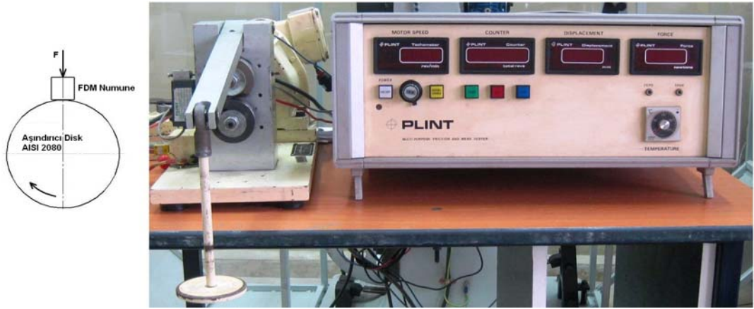
Şekil 2.2: Aşınma deneyi düzeneği
