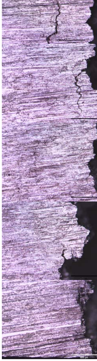
Şekil 3.19: SiC'ce zengin bölgeden (üst kısım) alüminyumca zengin bölgeye doğru kırık yüzeyin optik görüntüsü (büyütme 50x)
