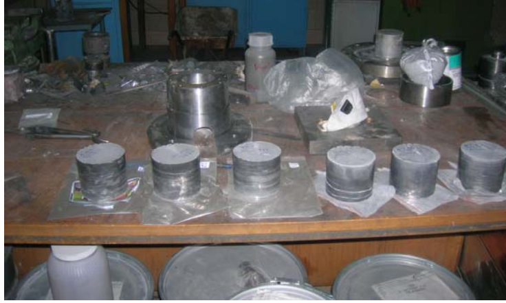
Şekil 6.7 : Ekstrüzyon işlemi öncesi kalıp ve preslenmiş numuneler
