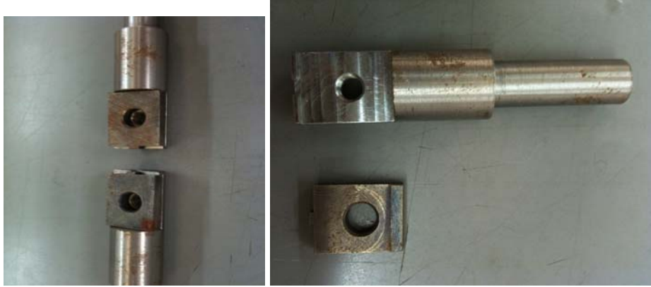
Şekil 6.29 : Çekme cihazına yerleştirilen çekme aparatı
