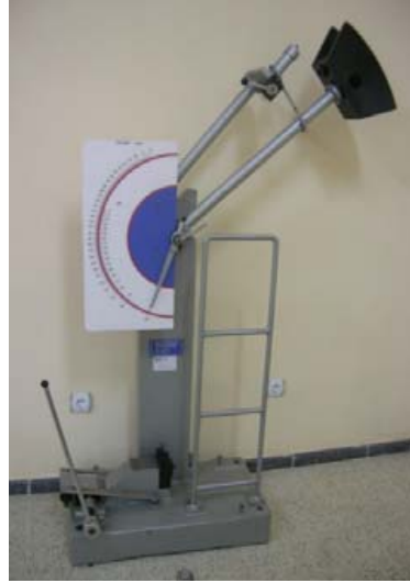
Şekil 6.32 : Impact charpy deney cihazı
