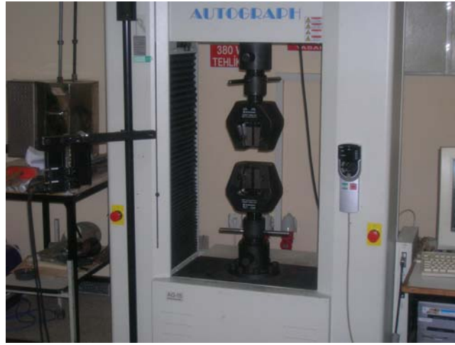
Şekil 6.27 : Shimadzu 250 kNG servo-hydraulic çekme cihazı
