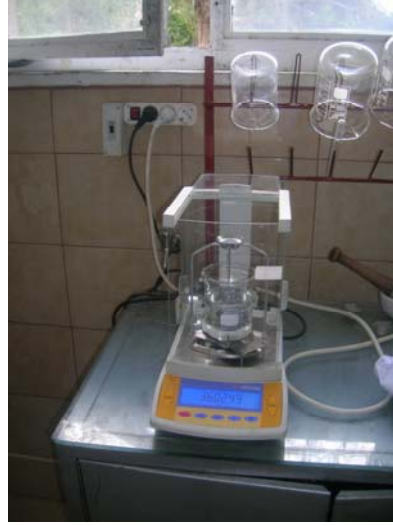
Şekil 6.26 : Sartorius marka yoğunluk ölçme cihazı
