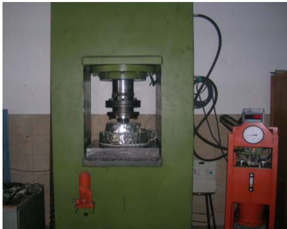
Şekil 6.12 : Hidrolik pres ve ısıtılan kalıp düzeneği
