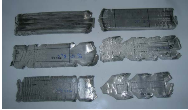
Şekil 6.13 : Ekstrüzyon işlemi neticesinde elde edilen blok numuneler
