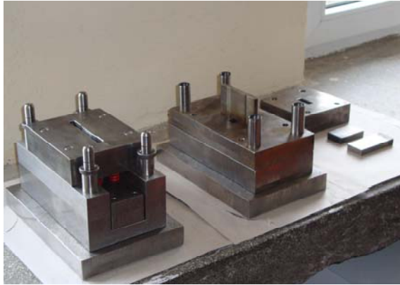
Şekil 6.3 : Çekme ve eğme deney numunelerinin basıldığı kalıp
