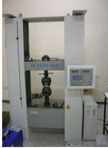
Şekil 6.31 : Servo-hydraulic eğme cihazı
