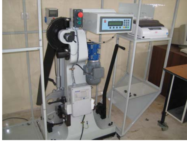
Şekil 6.33 : Dijital impact charpy deney cihazı
