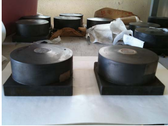
Şekil 6.21 : HPT işleminin kalıpları
