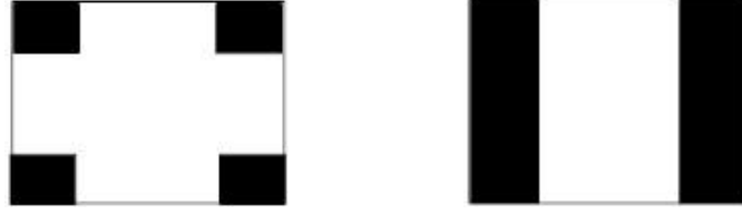
Şekil 3.2 Van der Pauw ve şerit kontak geometrisinde kontak alınmış ince filmler.
