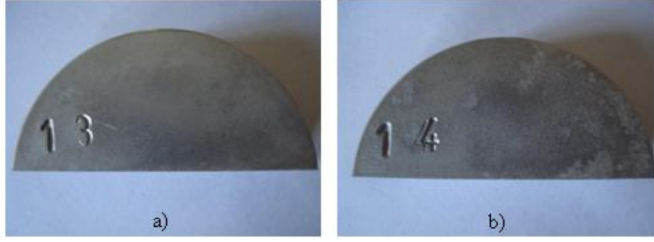
Şekil 4.2 : 2024 alaşımının SIMA sonrası makro yüzey görüntüsü 600°C’de a) 15 dakika b) 20 dakika SIMA
