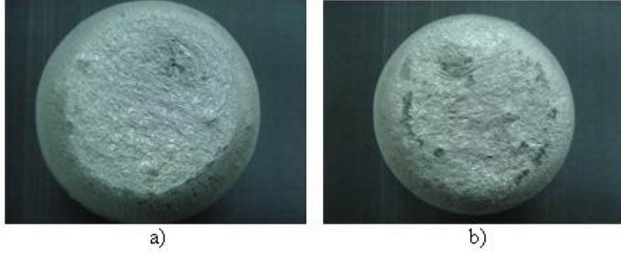
Şekil 4.109 : 2024 için kalıba a) ilk, b) son dökülen VAKT numunesinin yüzey görüntüsü
