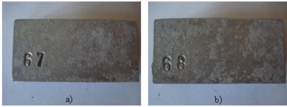
Şekil 4.16 : 7075 alaşımının SIMA sonrası makro yüzey görüntüsü 575°C'de a) 35 dakika b) 40 dakika SIMA
