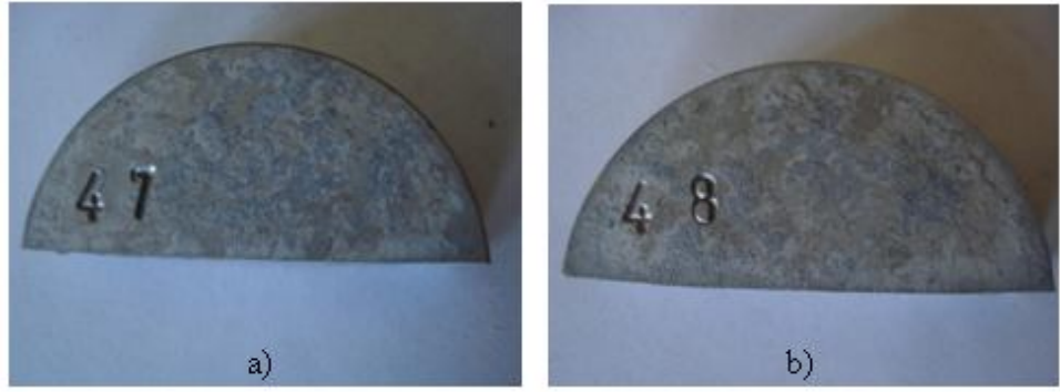
Şekil 4.7 : 2024 alaşımının SIMA sonrası makro yüzey görüntüsü 575°C'de a) 35 dakika b) 40 dakika SIMA
