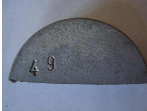
Şekil 4.8 : 2024 alaşımının SIMA sonrası makro yüzey görüntüsü 575°C'de 45 dakika SIMA
