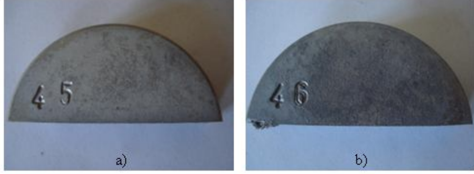
Şekil 4.6 : 2024 alaşımının SIMA sonrası makro yüzey görüntüsü 575°C'de a) 25 dakika b) 30 dakika SIMA
