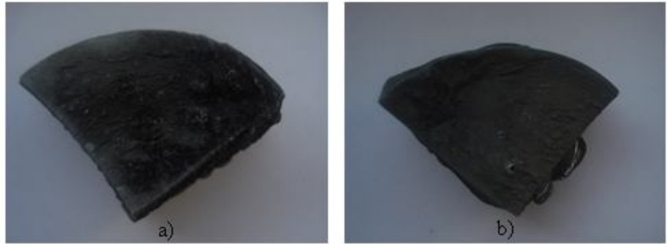
Şekil 4.24 : 2024 alaşımının SIMA sonrası makro yüzey görüntüsü 620°C’de a) 25 dakika b) 30 dakika SIMA
