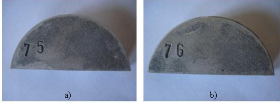
Şekil 4.3 : 2024 alaşımlının SIMA sonrası makro yüzey görüntüsü 550°C'de a) 25 dakika b) 30 dakika SIMA
