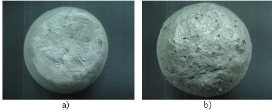
Şekil 4.111 : 7075 için kalıba a) ilk, b) son dökülen VAKT numunesinin yüzey görüntüsü
