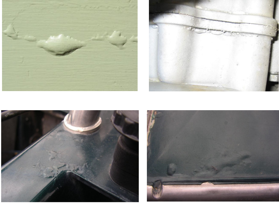
Şekil 2.20 : Metal ve alaşımların yüzeyinde blister oluşumu [28]
