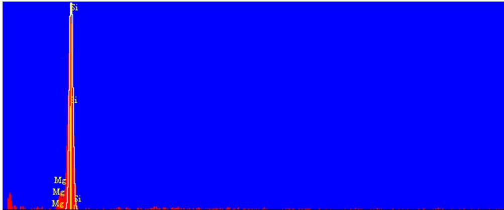
Şekil 4.104 : 80°C suda su verilmiş 6063 alaşımından yorulma numunesinin ( \sigma_{\max} = 0,9R_m ) SEM görüntüsü ve EDS analizi
