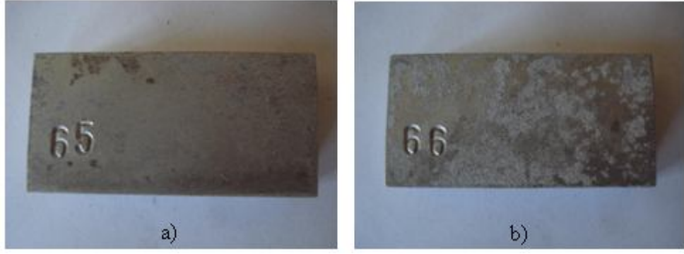
Şekil 4.15 : 7075 alaşımının SIMA sonrası makro yüzey görüntüsü 575°C'de a) 25 dakika b) 30 dakika SIMA
