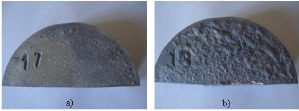
Şekil 4.10 : 2024 alaşımının SIMA sonrası makro yüzey görüntüsü 600°C'de a) 35 dakika b) 40 dakika SIMA
