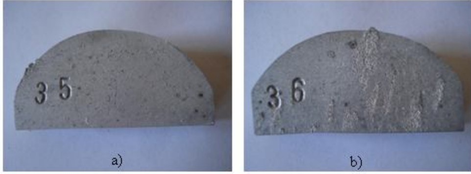
Şekil 4.18 : 7075 alaşımının SIMA sonrası makro yüzey görüntüsü 600°C'de a) 25 dakika b) 30 dakika SIMA
