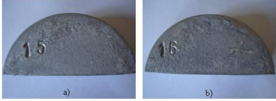
Şekil 4.9 : 2024 alaşımının SIMA sonrası makro yüzey görüntüsü 600°C'de a) 25 dakika b) 30 dakika SIMA
