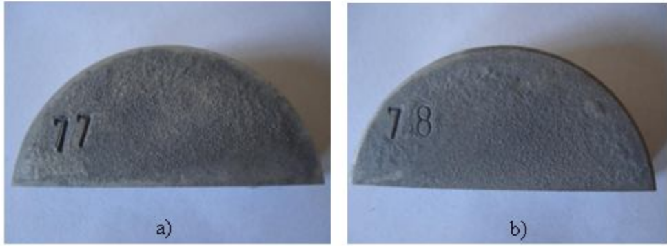
Şekil 4.3 : 2024 alaşımlının SIMA sonrası makro yüzey görüntüsü 550°C'de a) 25 dakika b) 30 dakika SIMA
