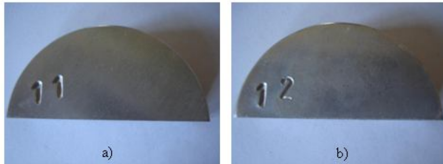
Şekil 4.1 : 2024 alaşımının SIMA sonrası makro yüzey görüntüsü 600°C’de a) 5 dakika b) 10 dakika SIMA
