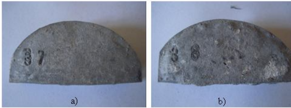
Şekil 4.19 : 7075 alaşımının SIMA sonrası makro yüzey görüntüsü 600°C'de a) 35 dakika b) 40 dakika SIMA
