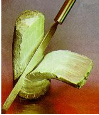
Şekil 2.3 : Yarı-katı durumda bıçak ile kesilen bir alüminyum alaşımı [20].
