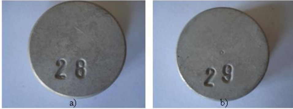
Şekil 4.22 : 6063 alaşımının SIMA sonrası makro yüzey görüntüsü 600°C'de a) 40 dakika b) 45 dakika SIMA
