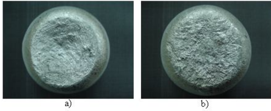
Şekil 4.110 : 6063 için kalıba a) ilk, b) son dökülen VAKT numunesinin yüzey görüntüsü
