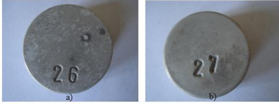
Şekil 4.21 : 6063 alaşımının SIMA sonrası makro yüzey görüntüsü 600°C'de a) 30 dakika b) 35 dakika SIMA
