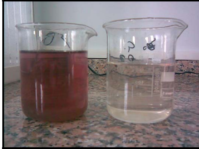
Şekil 8.2: Decolorant ile koagülasyon sonrası renk giderimi
