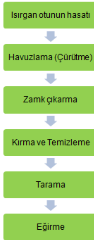
Şekil 3.2 : Isırgan otundan lif eldesinin aşamaları [9]
