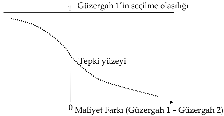
Şekil 2.5 SKD ataması için tepki yüzeyi
