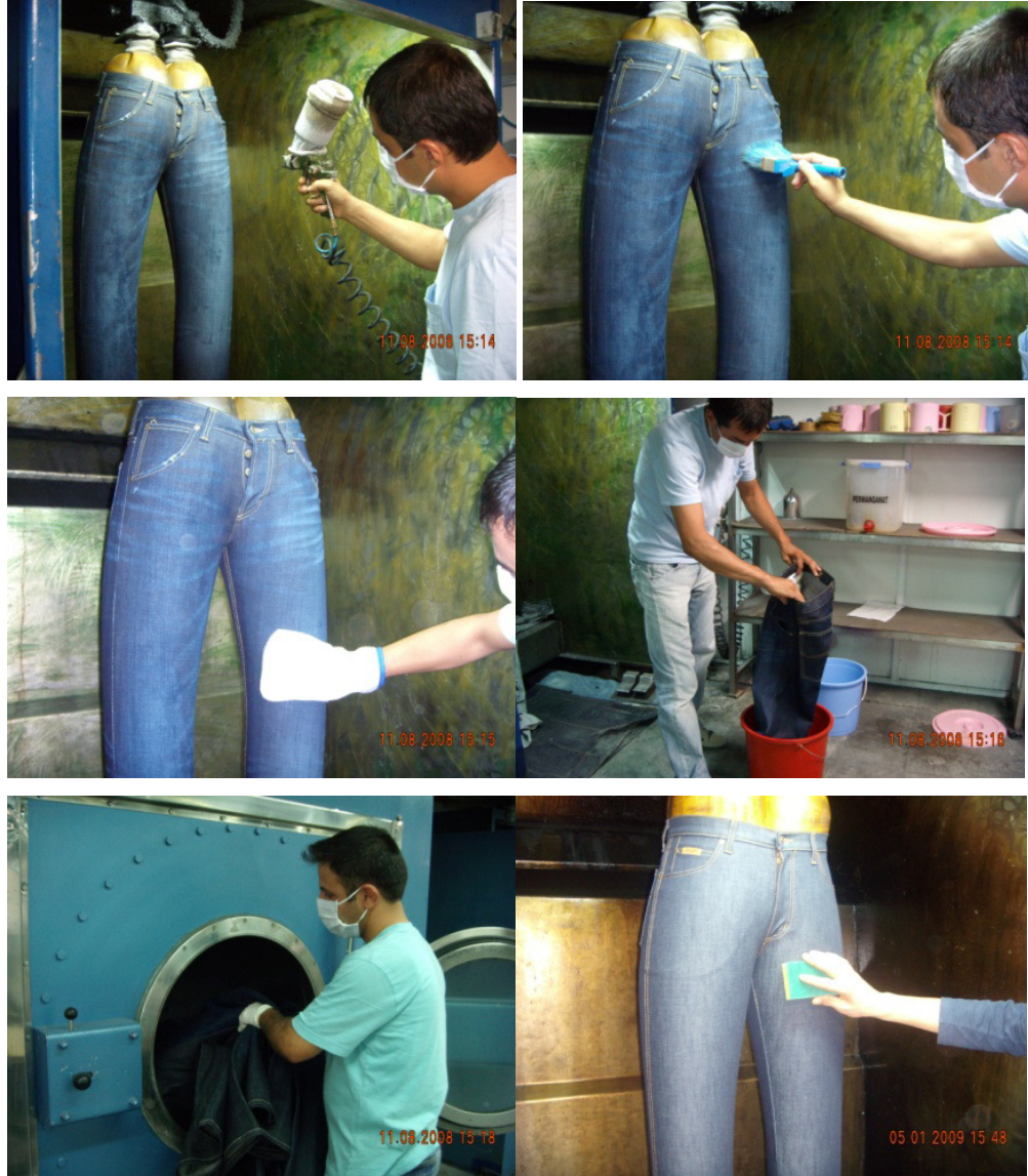
Şekil 2.15 Reçine Uygulama Teknikleri (spray tabancası ile, fırça ile, eldiven ile, daldırma ile, makinede, sünger ile) (Garmon Kimya, 2006)
