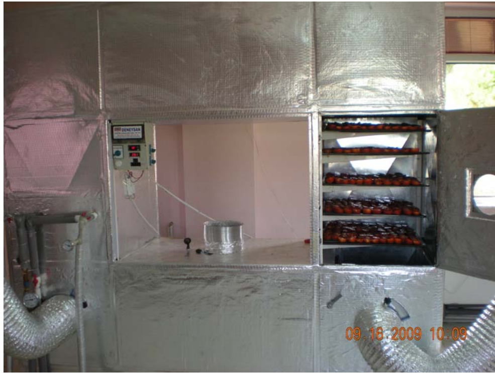
Şekil 5.9. Hazırlanan domateslerin tepsilerle kabin içerisine yerleşimi.
