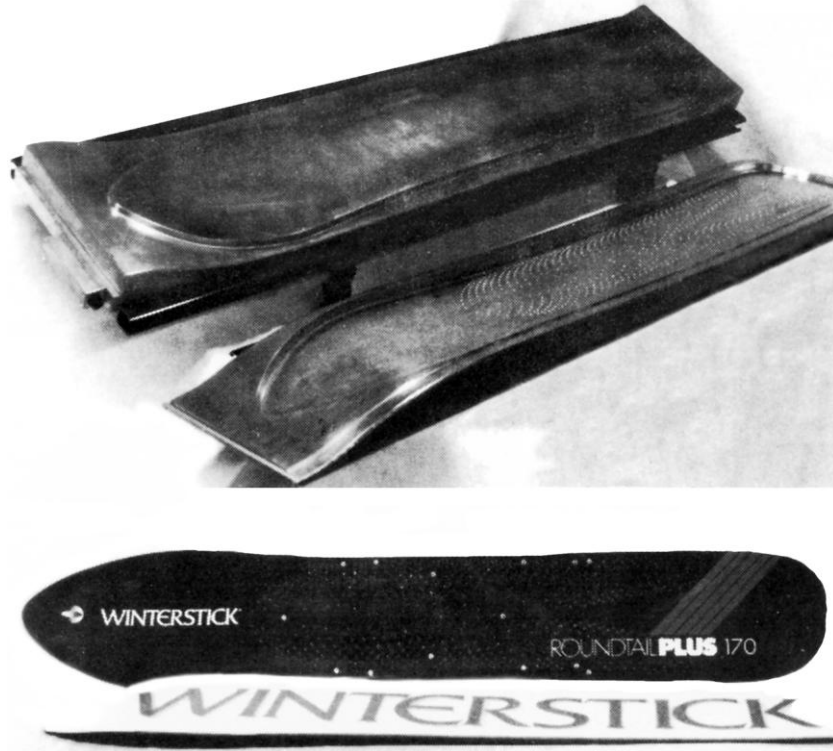
Şekil 1.3: Tek parça cam fiber/epoksi kayak malzemesi ve kalıbı.
