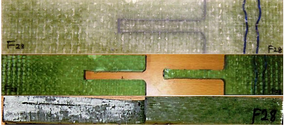
Şekil 4.49: Deney öncesi F28 numunesi ve deney sonrası oluşan hasarlar.
