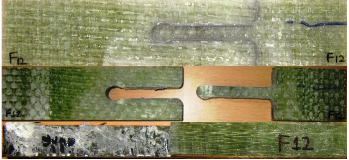
Şekil 4.35: Deney öncesi F12 numunesi ve deney sonrası oluşan hasarlar.
