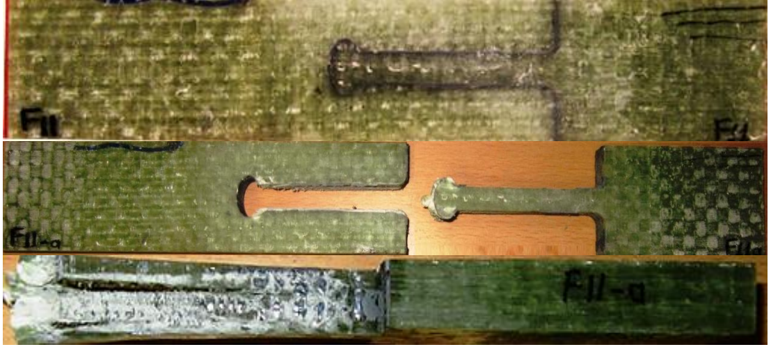
Şekil 4.26: Deney öncesi F11 numunesi ve deney sonrası oluşan hasarlar.
