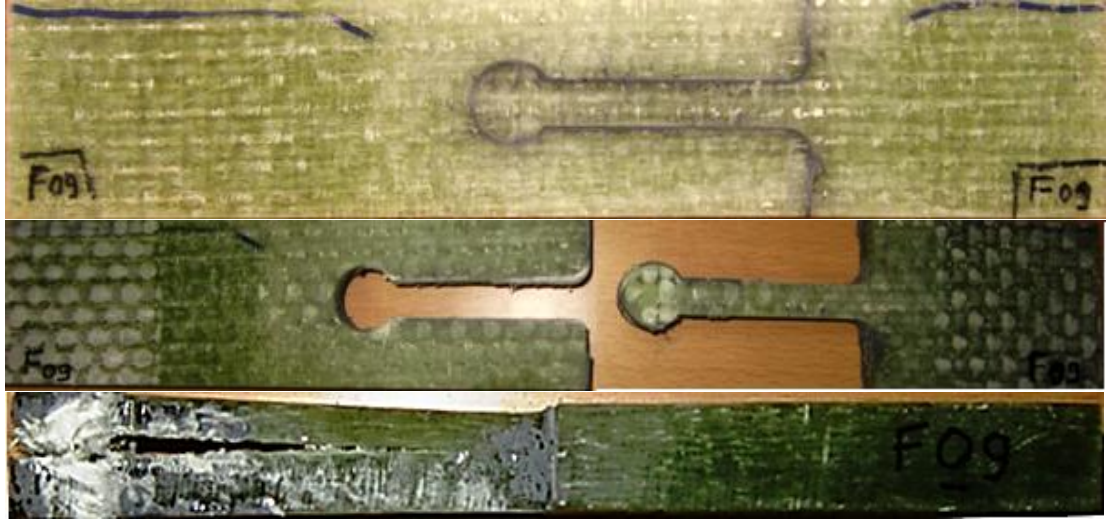
Şekil 4.36: Deney öncesi F09 numunesi ve deney sonrası oluşan hasarlar.
