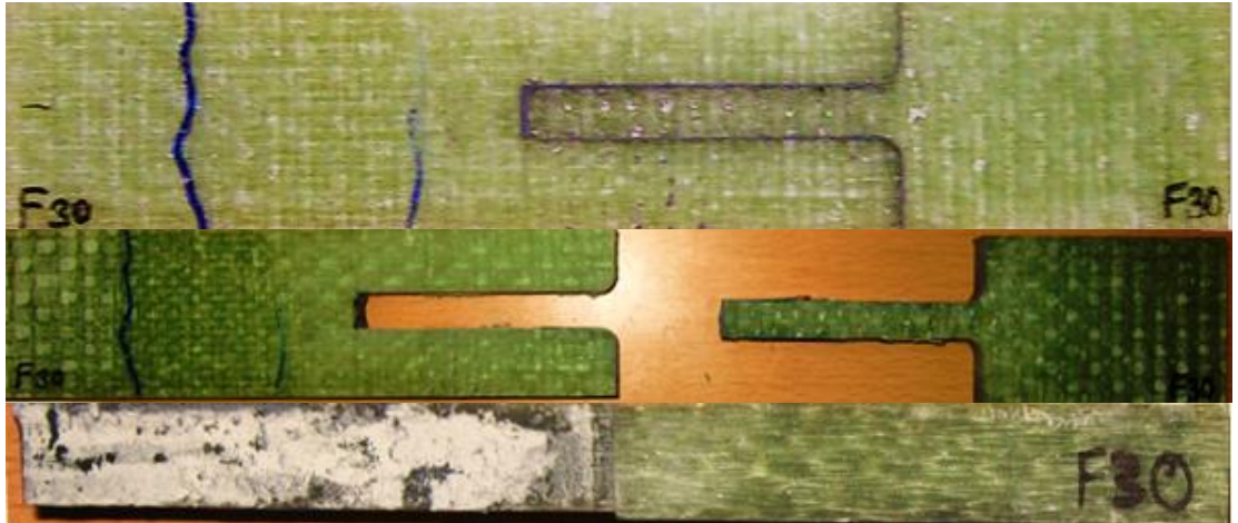
Şekil 4.44: Deney öncesi F30 numunesi ve deney sonrası oluşan hasarlar.
