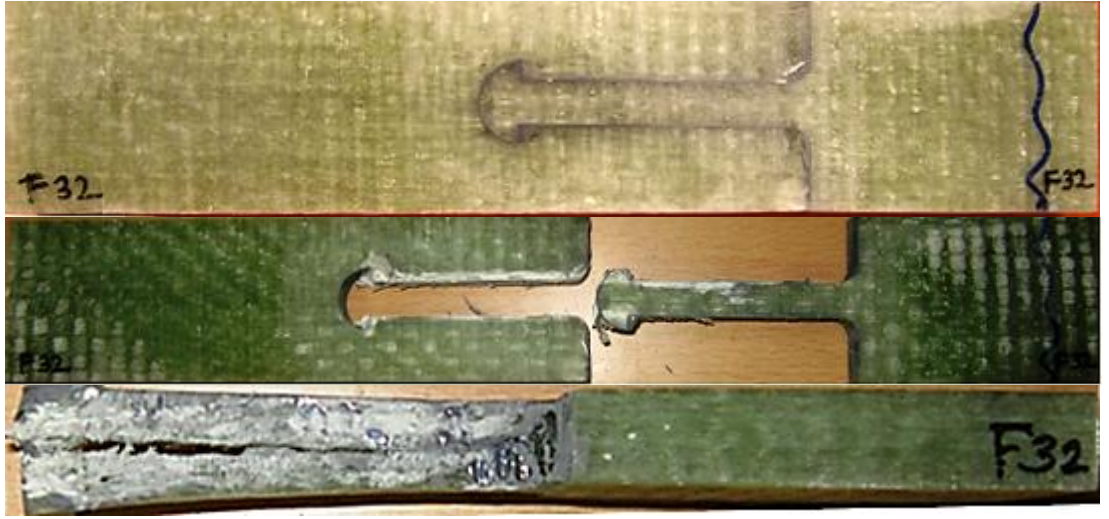
Şekil 6.3: Deney öncesi F32 numunesi ve deney sonrası oluşan hasarlar.
