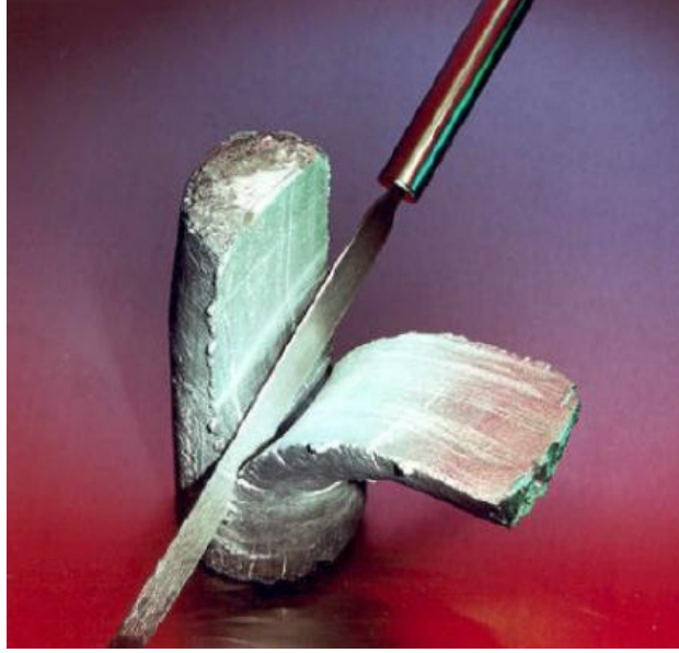
Şekil 1.9 : Yarı-katı haldeki alüminyum alaşımının bıçakla kesilmesi (Vinarcik, 2002).
