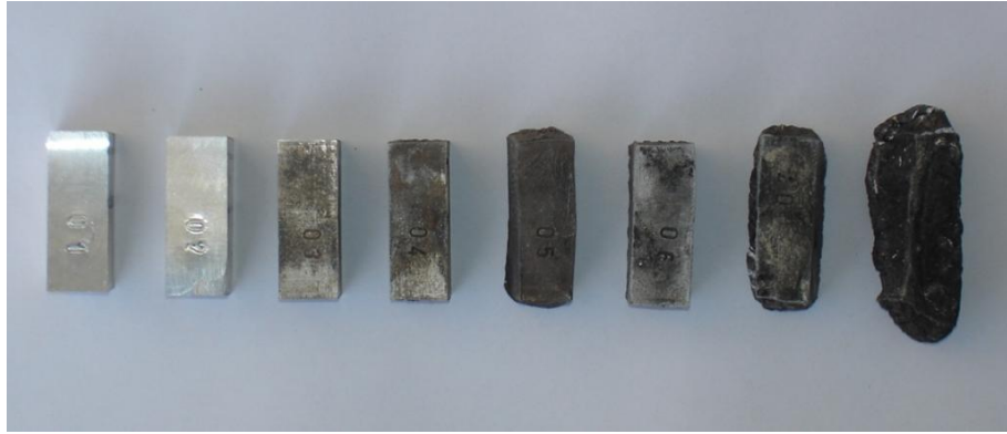
Şekil 2.5 : 630°C’de (soldan sağa) 5, 10, 15, 20, 25, 30, 35, 40 min bekletilen numuneler.
