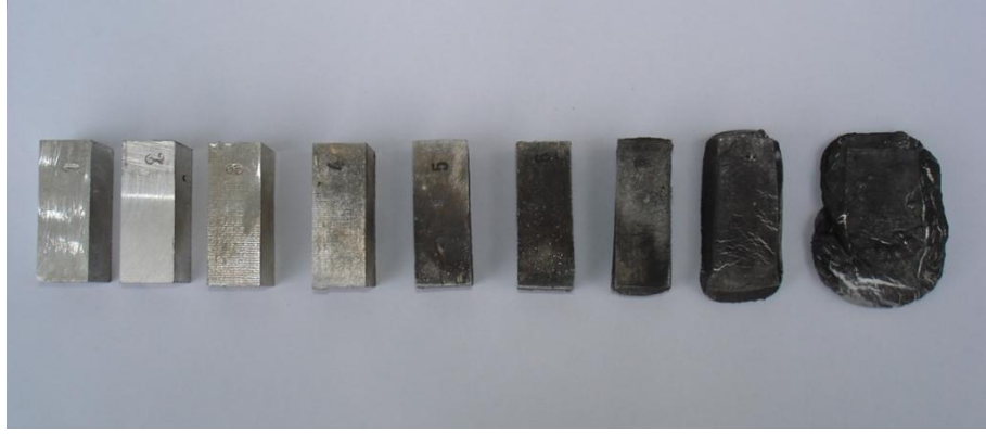
Şekil 2.4 : 620°C’de (soldan sağa) 5, 10, 15, 20, 25, 30, 35, 40, 45 min bekletilen numuneler.
