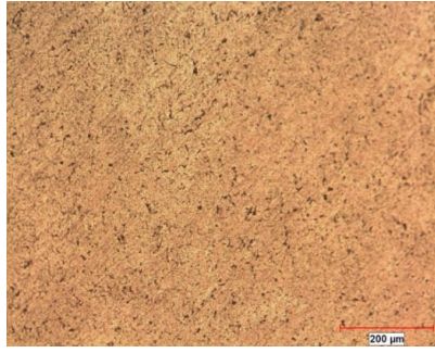
e) T0, makro dađlama çözeltisi, 30 s dađlama, ekstrüzyon yönüne dik, 100x
