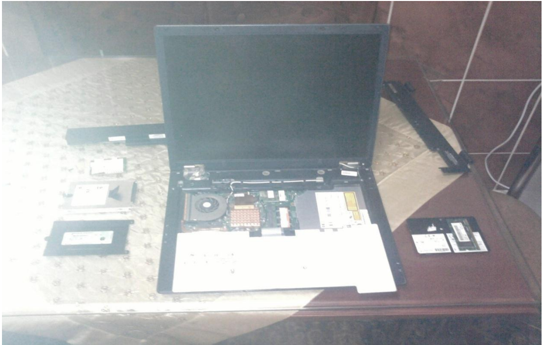
Şekil 4.9: Dizüstü bilgisayarın demontajı.
