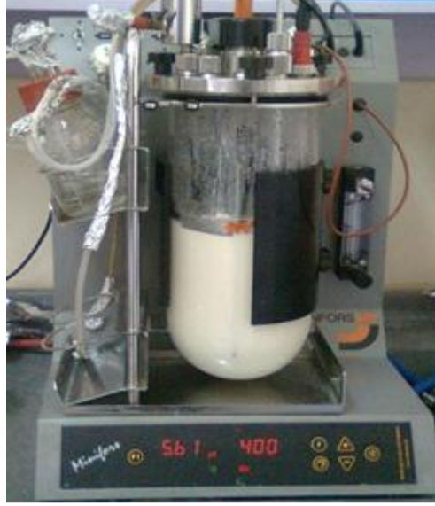
Şekil 2.1: Çalışmada kullanılan biyoreaktör sistemi
