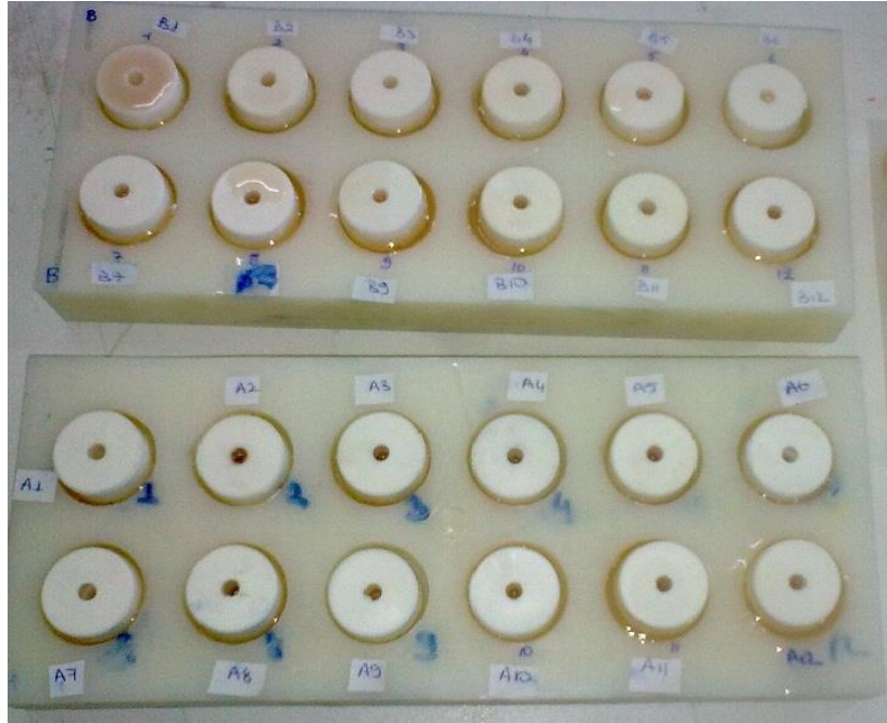
ekil 3.6: Polipropilen kal,plarda yap,lan embedding i lemi.
