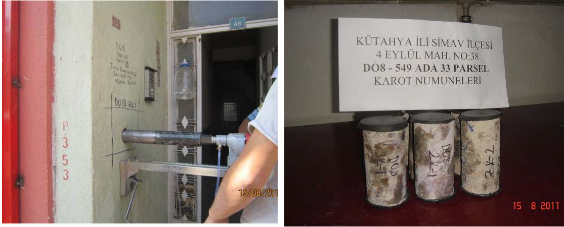
Resim 5.1: Çalışma sırasında karot numunesi alınması ve etiketleme işlemi
