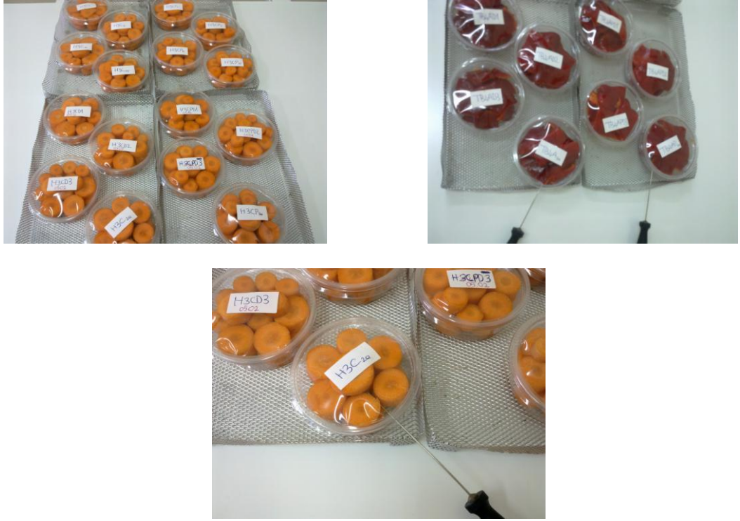
Şekil 3.8 : Havuç ve kırmızıbiber örneklerinin tepsilere dizilip sıcaklık problemlerinin bağlanması.
