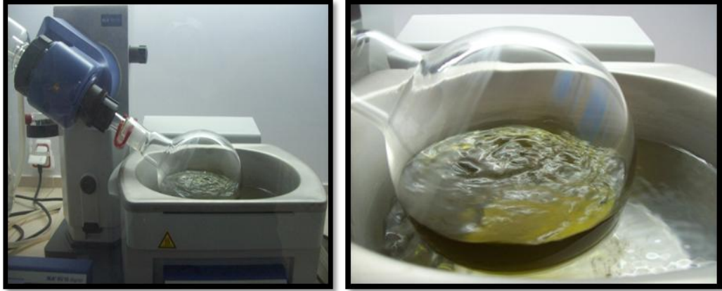
Şekil 2.2 : Rotary evaporatör ile çözücü uzaklaştırma işlemi.
