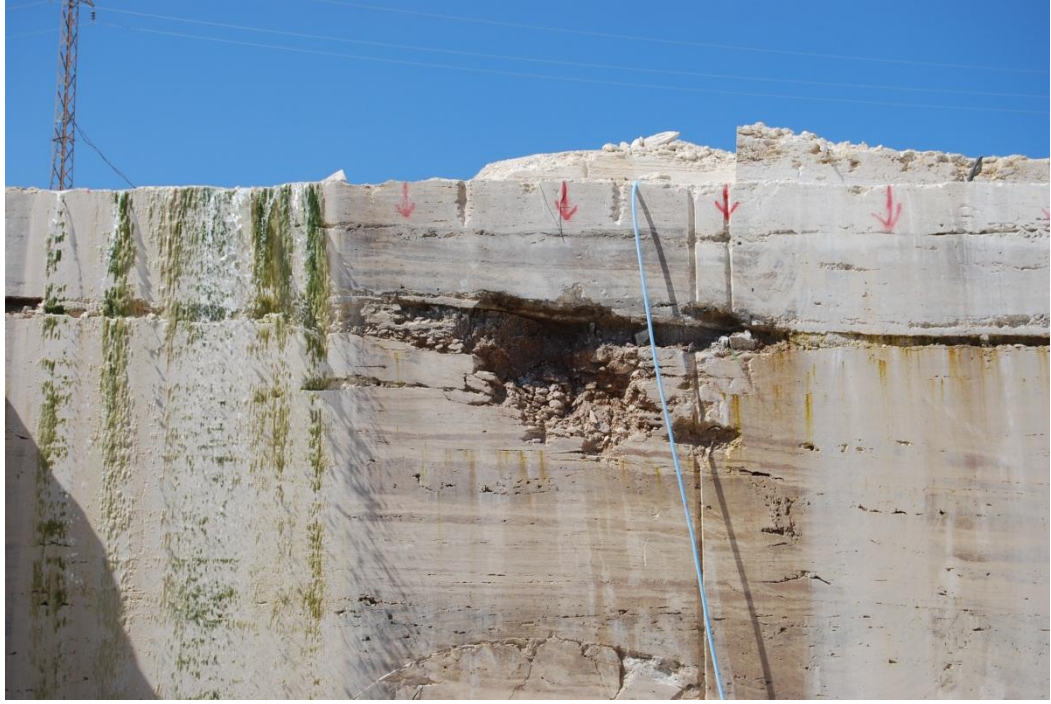
Şekil 6.3: Aşınma yüzeyindeki mağara tipi boşluğun içerisinde oluşan karstik toprak oluşumu. K.2.10 nolu ayna.
