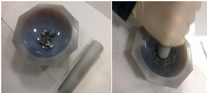
Şekil 3.2 Külçe halinde oluşturulan bileşiğin agat havanda toz haline getirilmesi
