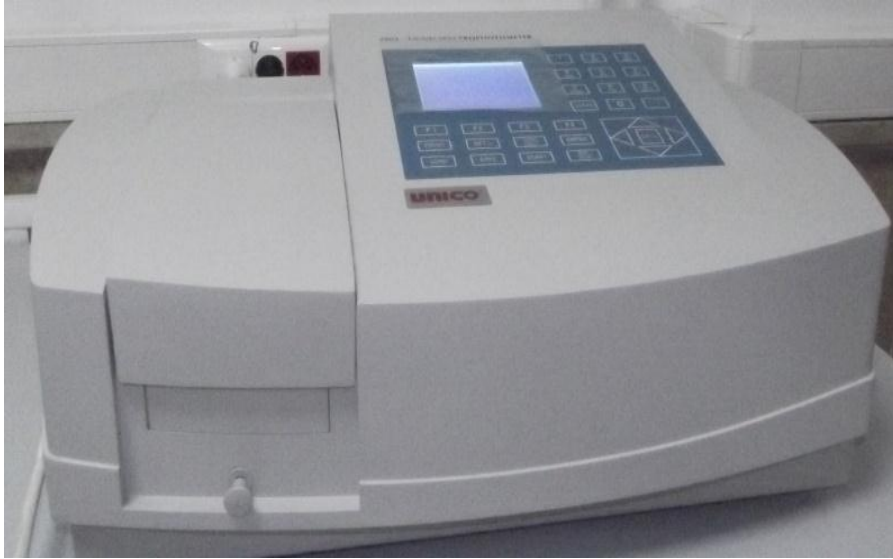
Şekil 3.17 Soğurma ölçümlerinde kullanılan UV-Vis spektrometresi
