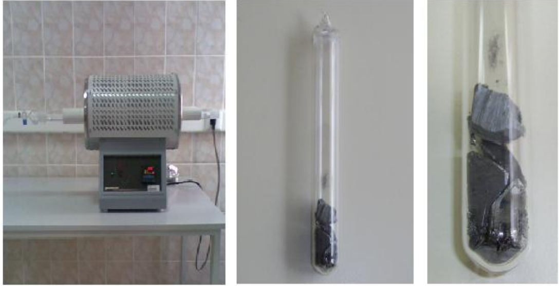
Şekil 3.1 Yatay fırın ve kuartz tüpler içinde sentezlenen numuneler
