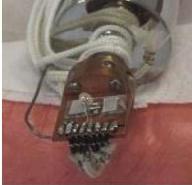
Şekil 3.11 Fotoiletkenlik ölçümü için kriyostat içerisine yerleştirilmiş numune ve LED'in fotoğrafı
