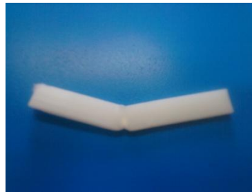
Şekil 4.10 : Kırılmayıp deforme olmuş numune
