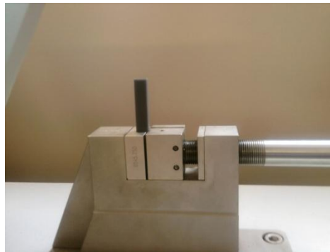
Şekil 4.2 : Deney numunesinin çentik (izod) darbe test cihazına bağlanması
