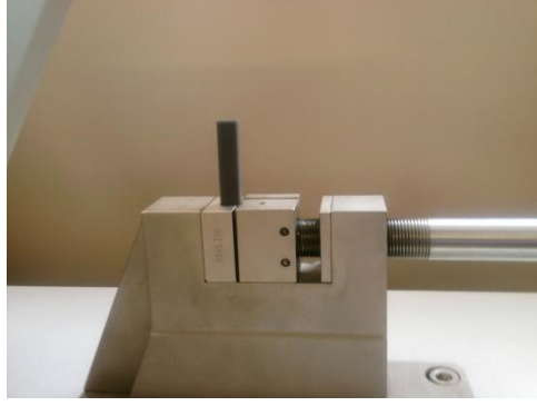
Şekil 4.8 : Numunenin cihaza bağlanış şekli
