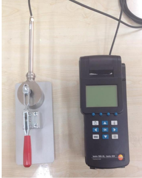
Şekil 2.8: Su aktivitesi ölçüm setinin genel görünümü
