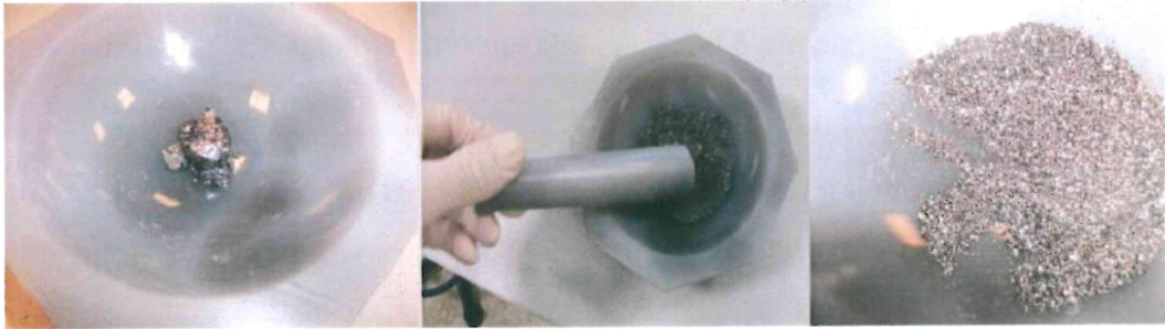
Şekil 3.2: Külçe halinde sentezlenen numunenin agat havanda toz haline getirilmesi
