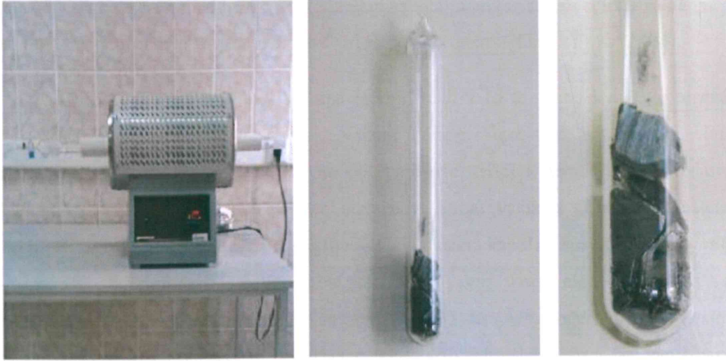
Şekil 3.1: Yatay fırın ve kuartz tüpler içinde sentezlenen numuneler
