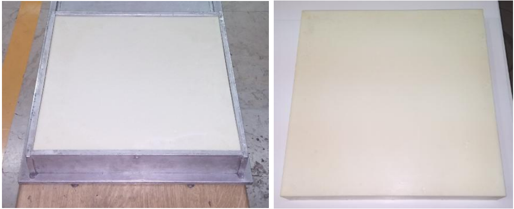
Şekil 3.9: a) 30 dakika sonra malzemenin kalıptan çıkarılması, b) 30 dakika sonra kalıptan çıkan köpük.
