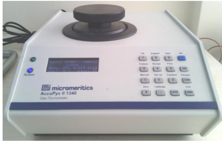
Şekil 3.15: Köpük malzemelerin kapalı hücre oranlarının belirlenmesinde kullanılan piknometre cihazı.
