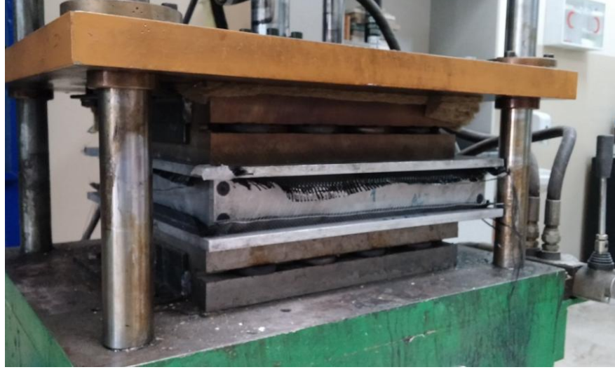
Şekil 3.8: Isıtıcıli prese yerleřtirilen kalıpta malzemenin kabarmaya bırakılması.
