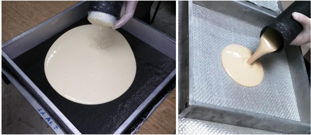
Şekil 3.7: a) Karbon elyaf kumaş üzerine karışımın dökülmesi, b) Cam elyaf kumaş üzerine karışımın dökülmesi.
