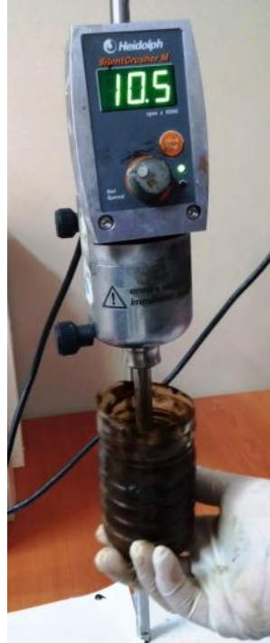
Şekil 3.4: Poliöl ile dolgu maddelerinin homojenizatör yardımıyla karıştırılması.
