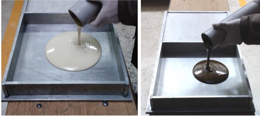
Şekil 3.6: Mekanik karıştırma işleminin ardından malzemelerin kalıba dökülmesi.
