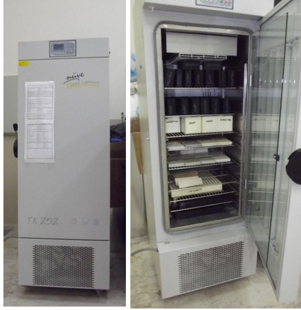
Şekil 3.16: Nüve TK252 şartlandırıcı ünitesi.
