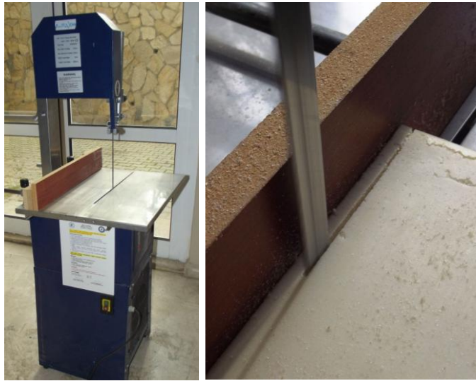
Şekil 3.11: Üretilen köpük malzemelerin testler için gereken boyutlara getirilmesinde kullanılan şerit testere.
