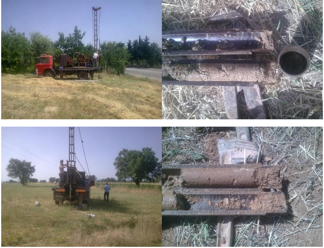
Şekil 3.1: İnceleme Alanı Sondaj Çalışmalarından ve Alınan SPT numunelerinden görüntüler (Şekerci, 2014).
