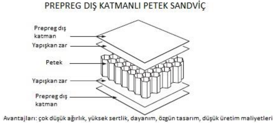
Şekil 17: Sandviç yapı örneği
