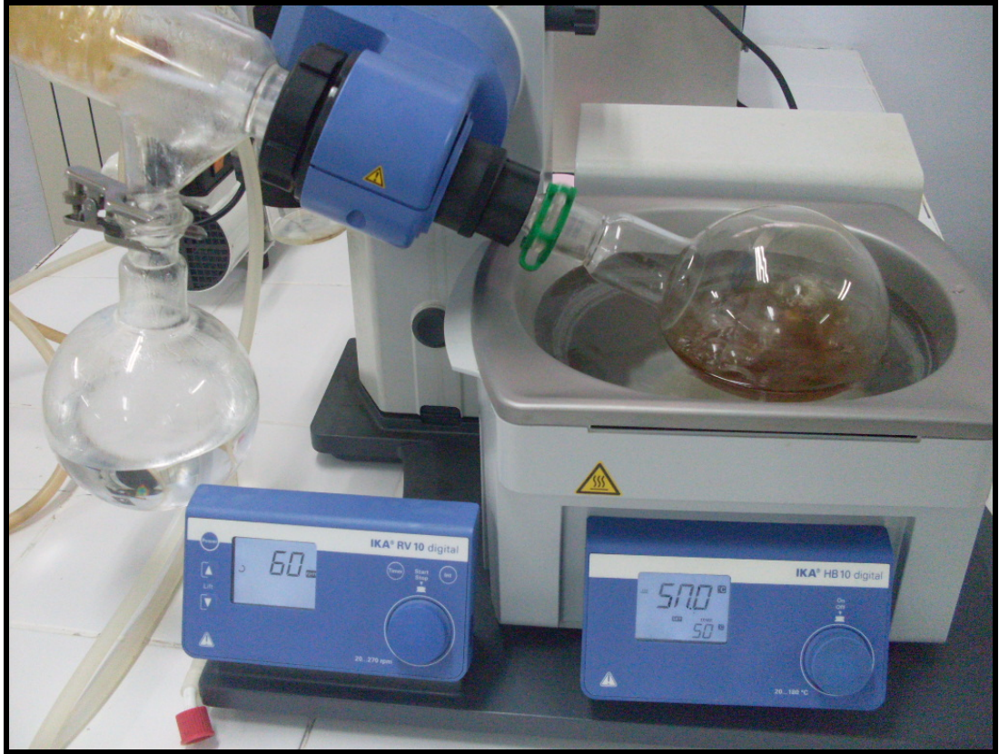
Şekil 3.11: Bitkisel ekstraksiyonların evaporatörde kloroformdan uzaklaştırılması.
