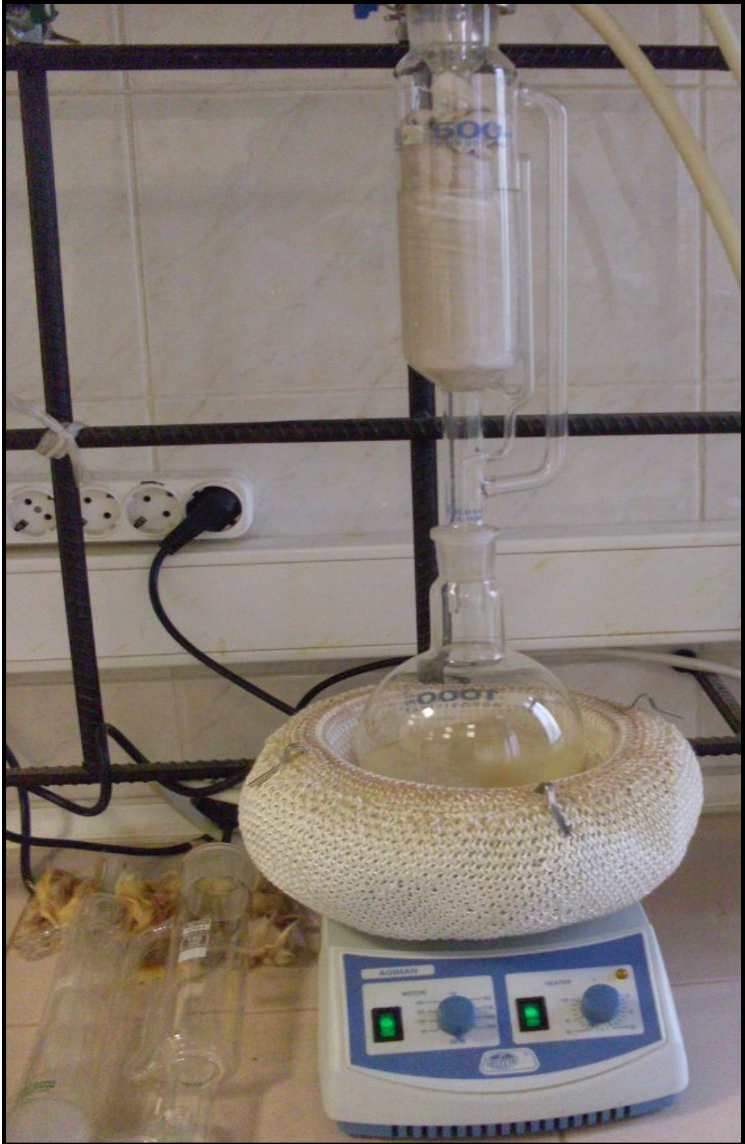
Şekil 3.9: Sokslet cihazı ile bitkisel materyalin ekstraksiyon işlemi.
