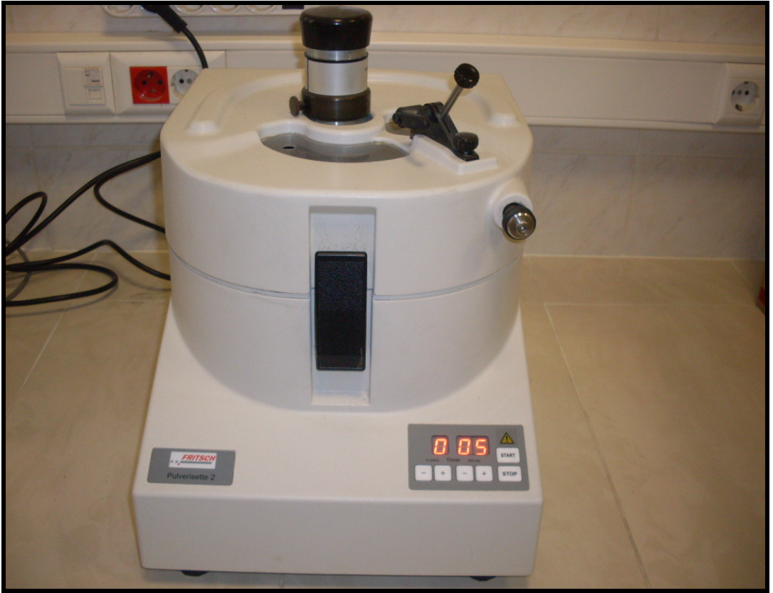
Şekil: 3.7: Küçük parçalara ayrılan kurumuş bitki köklerinin toz haline getirilmesi.
