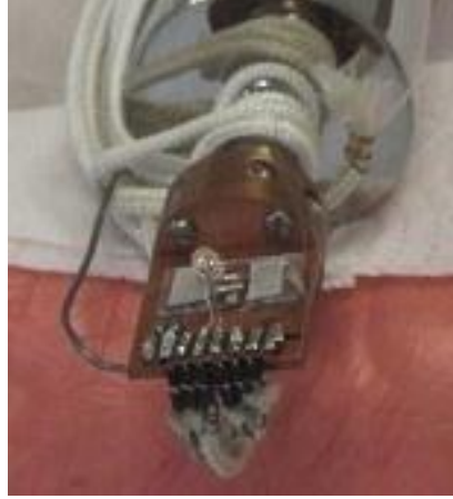
Şekil 3.10: Fotoiletkenlik ölçümü için kriyostat içerisine yerleştirilmiş numune ve LED'in fotoğrafı (Kamaç 2013).
