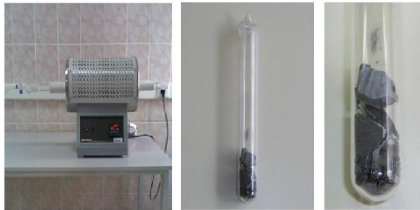
Şekil 3.7: Yatay fırın ve kuvartz cam tüp içerisinde sentezlenen numuneler (Kamaç 2013).
