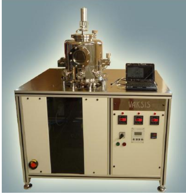
Şekil 3.2: Termal buharlaştırma sistemi (Gölcür 2012).
