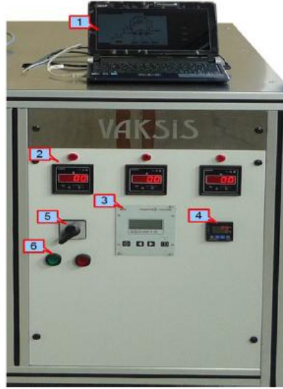
Şekil 3.5: Termal buharlaştırma sisteminin elektronik kabin ünitesi 1) Kontrol bilgisayarı, 2) Ampermetreler ve termal buharlaştırma güç kaynakları göstergeleri, 3) Turbo pompa kontrolör, 4) Sıcaklık PID kontrolör, 5) Ana şalter, 6) Aç/Kapa Anahtarları (Kamaç 2013).
