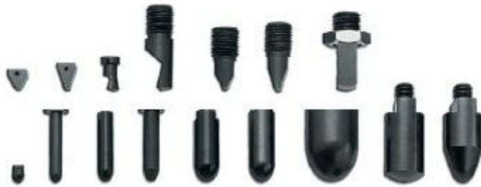
Şekil 5.13 : Ağırlık düşürme test cihazı ile kullanılacak değişik vurucu uçlar.
