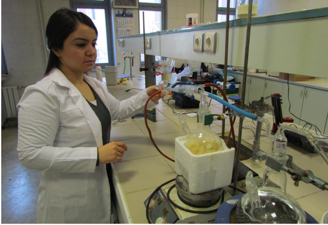
Şekil 2.3 : Su buhar distilasyon yöntemi ile sarımsak uçucu yağının elde edilmesi.
