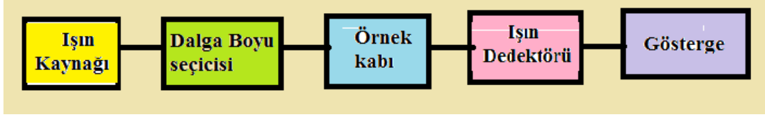
Şekil 2.22 : Bir spektrofotometrenin temel bileşenleri.
