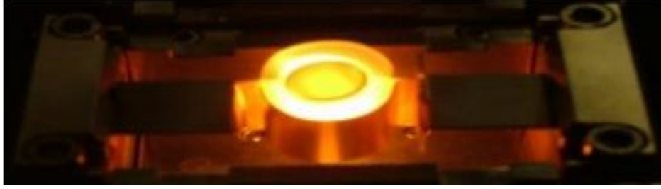
Şekil 3.6: Termal buharlaşma sisteminde akım uygulanan pota içindeki malzemenin görüntüsü
