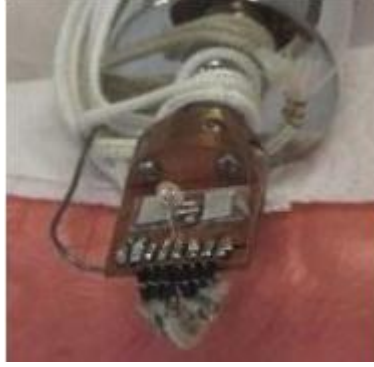
Şekil 3.14: Kriyostat içerisine yerleştirilmiş numune ve LED'in görünümü
