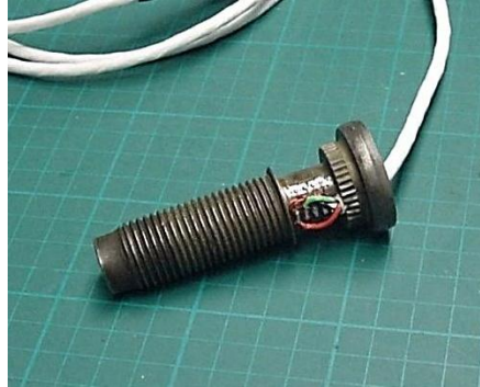
Şekil 2.14 : Uzama ölçerli cıvata [23].
