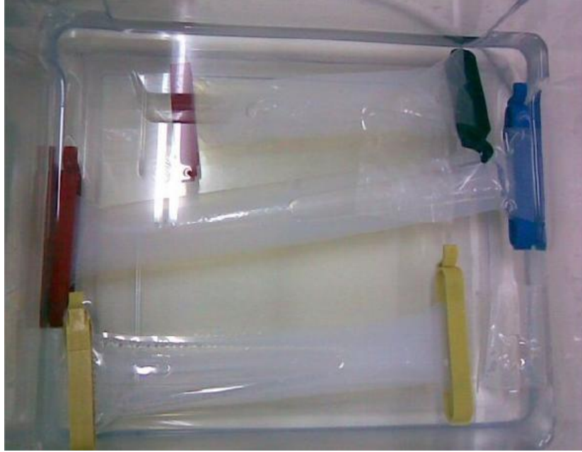
Şekil 3.2: Diyaliz membran ile solların pH ayarlaması (Ceyhan, 2011)
