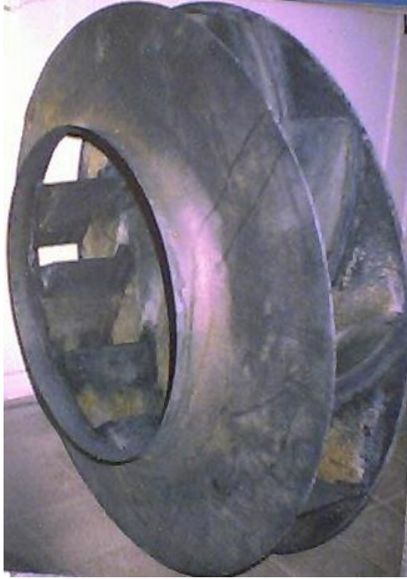
Şekil 2.8 Çimento fabrikasında kullanılan fan (Karaman 2003)
