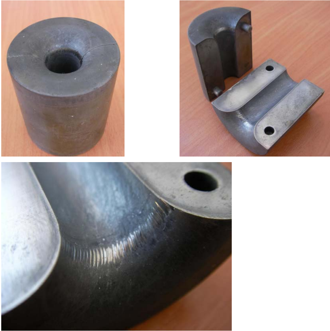
Şekil 4.26 Kompklama matrisinde aşınma izleri
