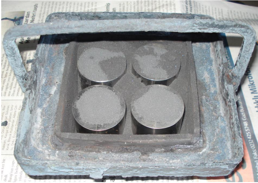
Şekil 3.7 Borlama için hazırlanmakta olan kutunun görünümü
