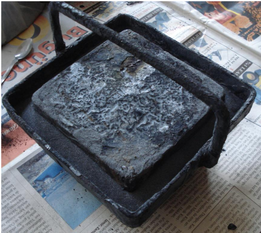
Şekil 3.8 Borlama için hazırlanmış kutu
