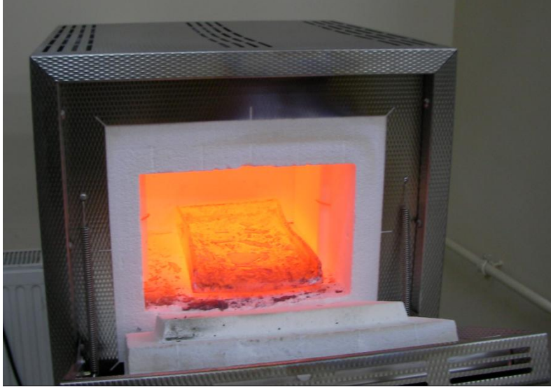
Şekil 3.9 Borlama için hazırlanmış 950°C deki fırın
