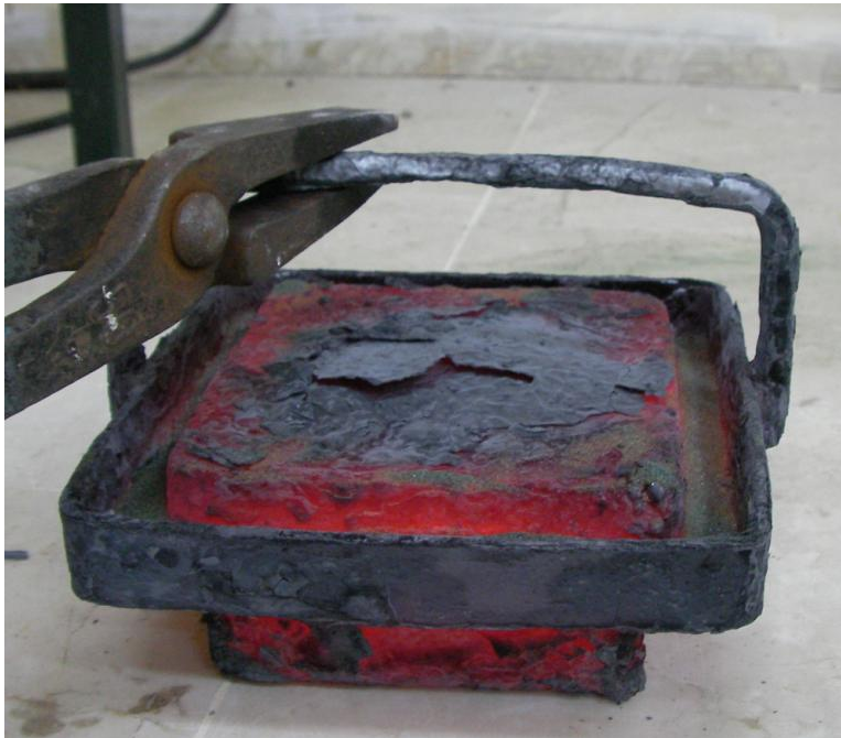
Şekil 3.10 Borlama işlemi tamamlandıktan sonra kutunun fırından çıkarılarak soğumaya bırakılması
