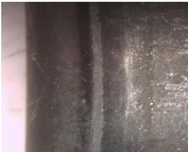
Şekil 4.30 Çelik tellerin dönerek geldiği sistemde kullanılan kompaktlama matrisinde çevresel aşınma izlerinin görüntüsü
