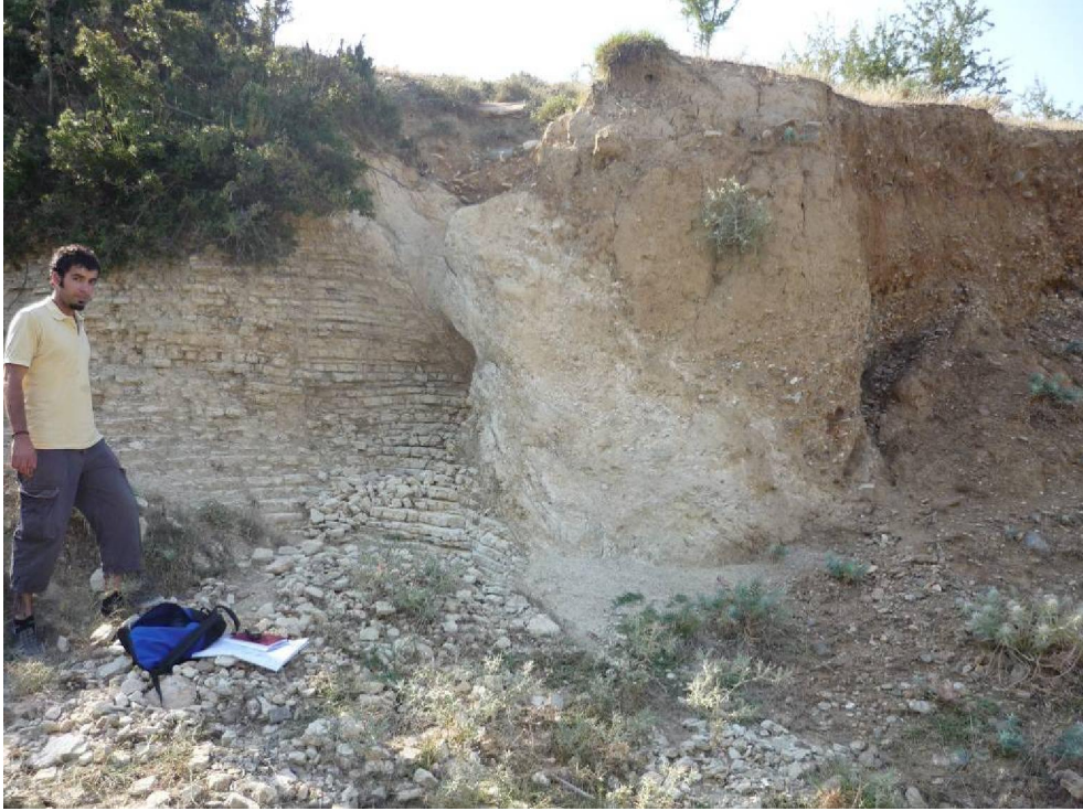
Şekil 3.22 : Kolankaya formasyonundaki marnlar (Ahıllı marn üyesi) ve çakıltaları (Mollaahmetler çakıltası üyesi) arasındaki faylanma.
