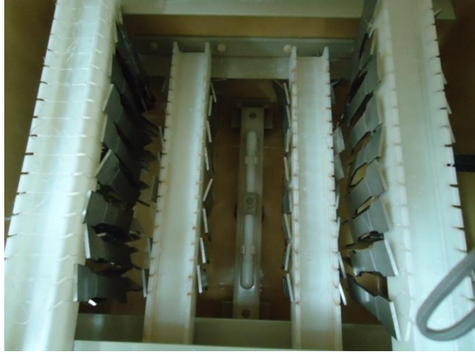
Şekil 6.32 : Numunelerin tuz püskürtme kabini içerisindeki yerleşim düzeni.
