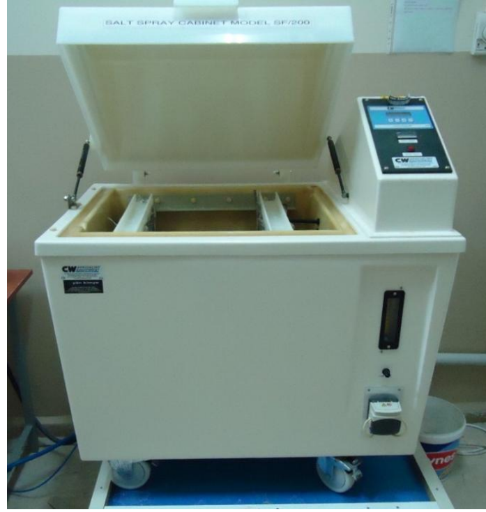
Şekil 6.31 : Deneyleerde kullanılan tuz püskürtme kabini.
